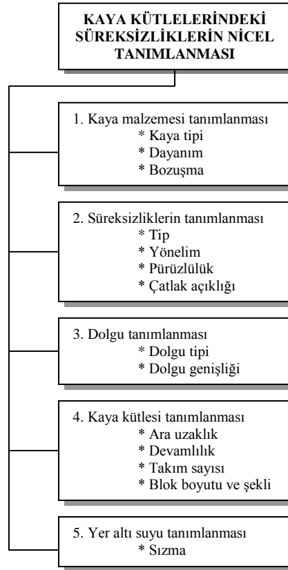
Şekil 2.2. Kaya kütlesi özelliklerini tanımlayan parametreler (Wyllie ve Mah, 1999).
