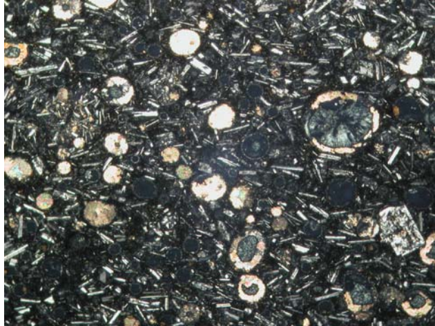
Şekil 11. Çağlayan Formasyonu'ndan alınan bazalt örneklerinde mikrolitik porfirik doku (ÇN)
