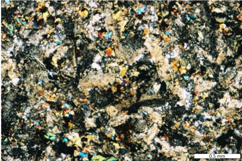
Şekil 17. İnce taneli metabazik örneğinin mikroskobik görünümü. Açık sarımsî renkli mineraller ayrılmış feldspat minerallerini göstermektedir (ÇN).
