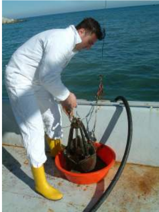
Şekil 7. Dip çökellerinin portakal kabuğu keçesi ile örnekleme
