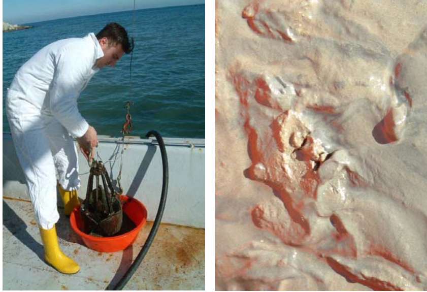
Şekil 10 Dip sedimanlarının örneklenmesi ve yüzey tabakanın görünümü
