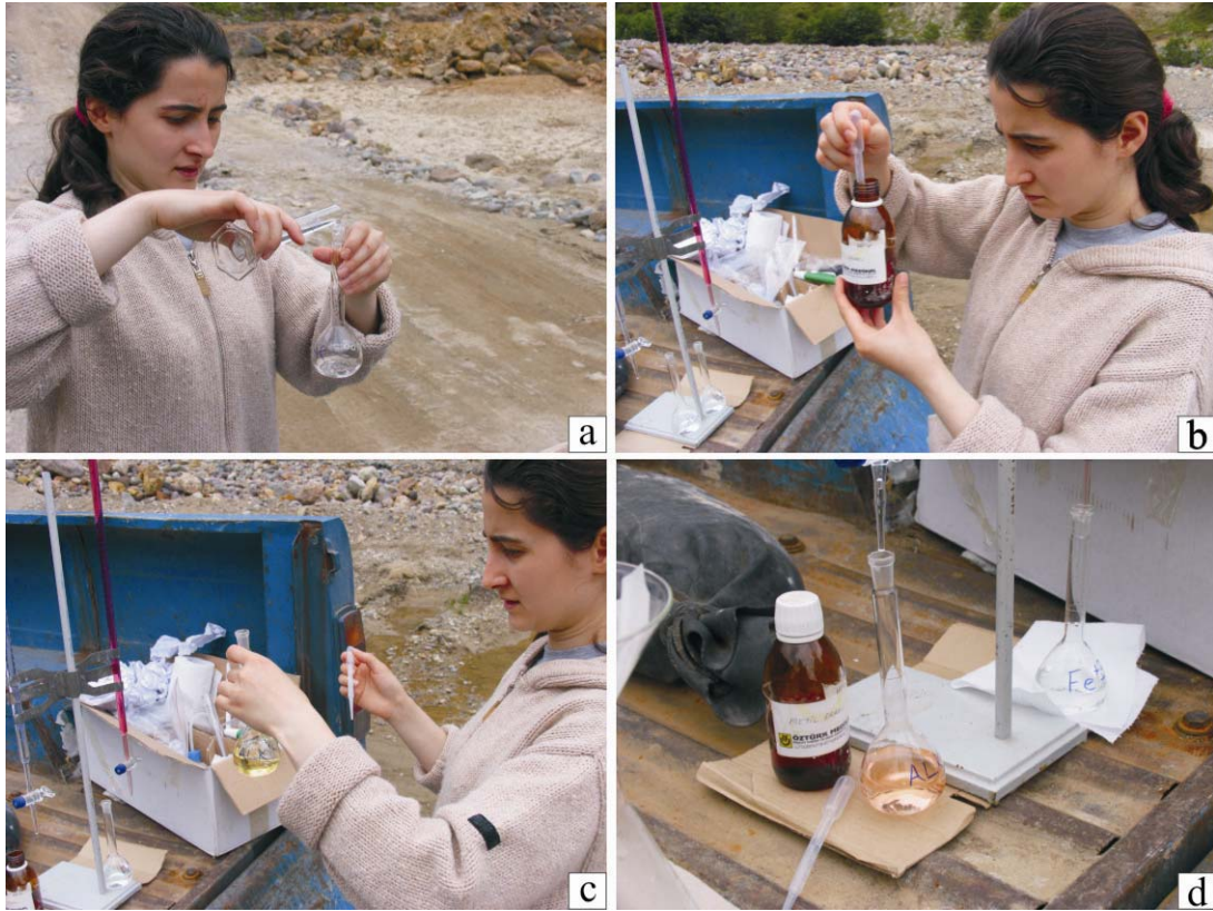
Şekil 2.5. a) Alkalinite ölçümü için 50 ml su örneğinin hazırlanması, b) Renk dönüşümü için gereken metil oranjin pipete çekilmesi, c) Su örneğine metil oranjin eklenmesi ve rengin sarıya dönüşü d) Asit titrasyonu sonucu suda pembe rengin oluşumu
