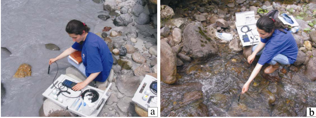
Şekil 2.4. a) Murgul Deresinde ham su örneğinde yapılan iletkenlik ölçümü, b) Damar Dere üzerinden ham su örneğinde çözülmüş oksijen ölçümü
