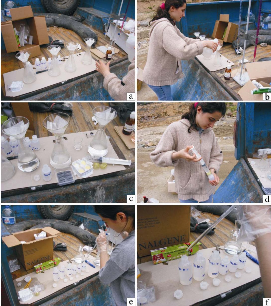
Şekil 2.2. a) ve b) Su örneğinin süzülmesi, c) ve d) Su örneğinin filtrelenmesi, e) ve f) Şişelenen su örneklerinin asitleştirilmesi
