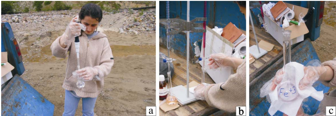
Şekil 2.6. a) Fe +3 'ün ölçümü için alınan 50 ml'lik su örneğine 1 ml derişik H 2 SO 4 eklenmesi, b) Çözeltinin KMnO 4 ile titre edilmesi c) Çözeltinin leylak rengine dönüşmesi
