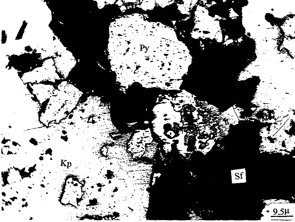
Şekil 8. Sarı cevher içersinde yer alan kalkopiritin pirit ve sfaleriti ornatması (Py: pirit, Kp: Kalkopirit, Sf: Sfalerit)
