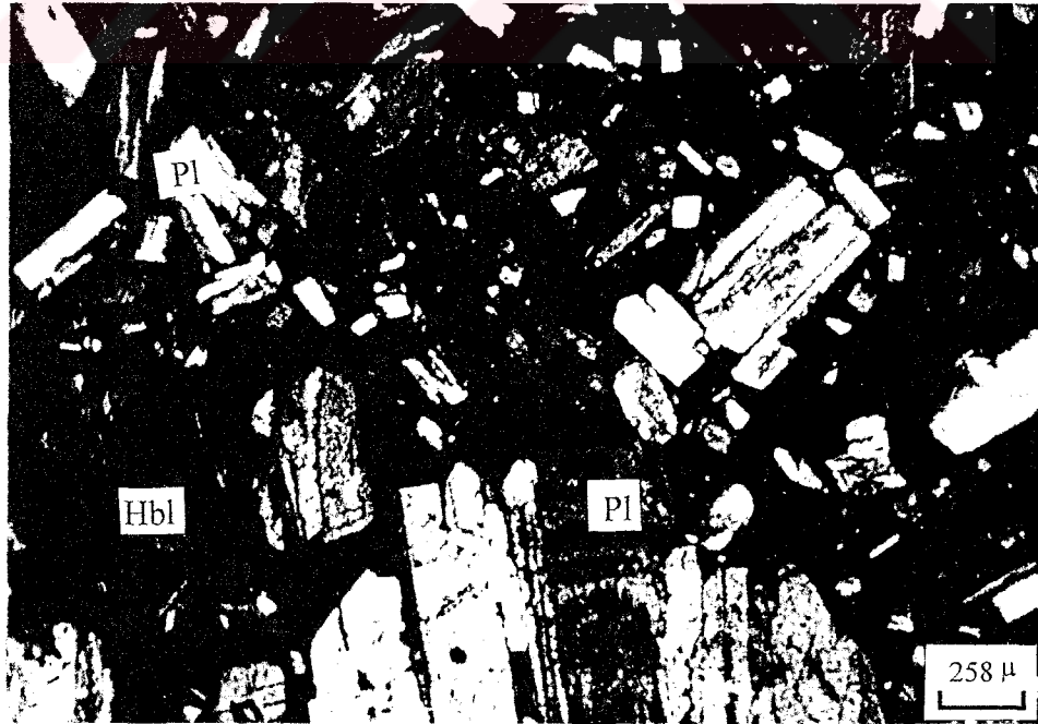
Şekil 31. Breşlerdeki andezitik çakıllarda gözlenen plajiyoklasların sunduğu karmaşık ikizlenme (Ç.N.; Pl:Plajiyoklas, Hbl:Hornblend )(Örnek No: B8)
