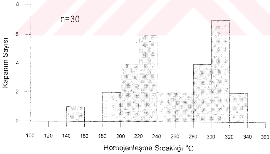
Şekil 68. Maden cevherleşmesinden alınan kuvarslardaki birincil kapanımların homojenleşme sıcaklığını gösteren histogram.
