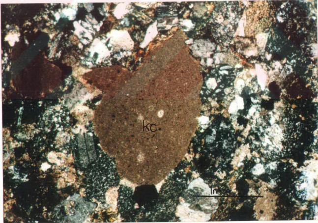
Şekil 23: Çalidere Ölçülü Stratigrafik Kesitinden alınan kumtaşı örneğinin ince kesit görünümü (kç: Kireçtaşı parçası).
