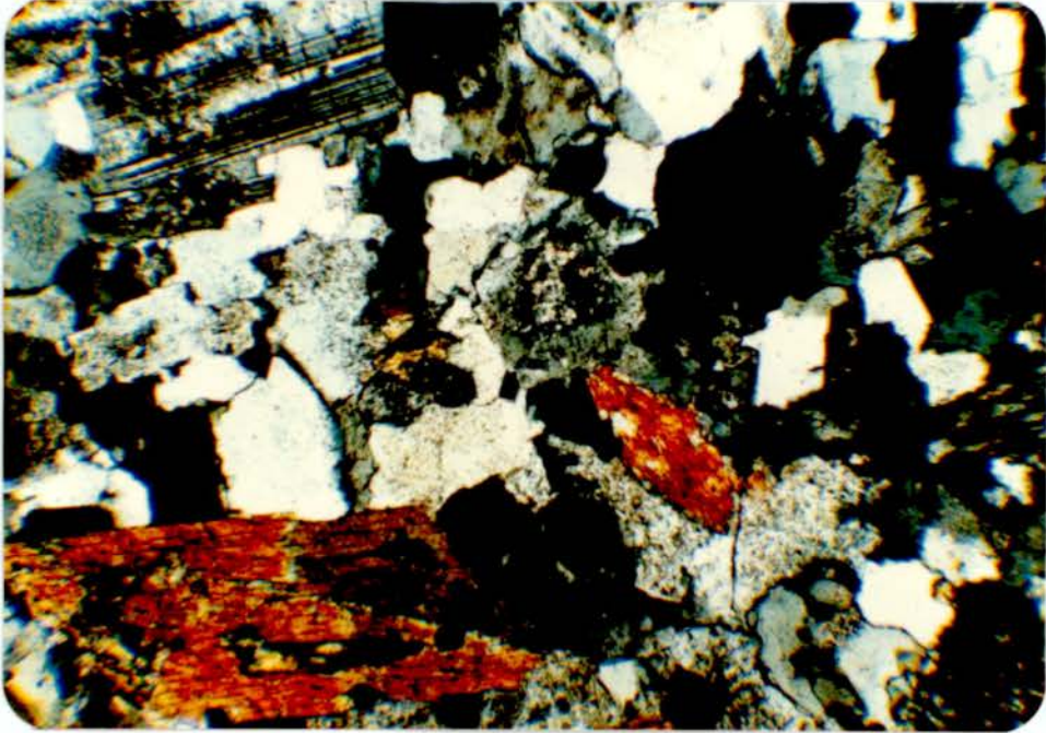
Şekil 3.6. Granitlerdeki taneli dokunun ve amfibollerdeki h'(100) ikizinin mikroskopik görünümü Kesit No: H-55, Ç.N.X63.
