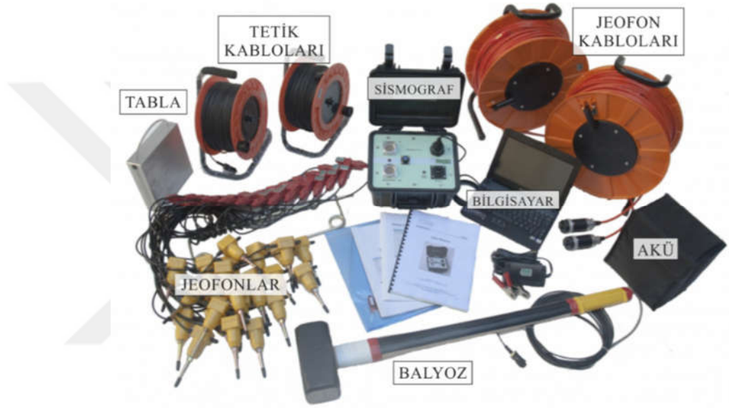
Şekil 4.3. MASW yöntemi için arazide kullanılan ekipmanlar
