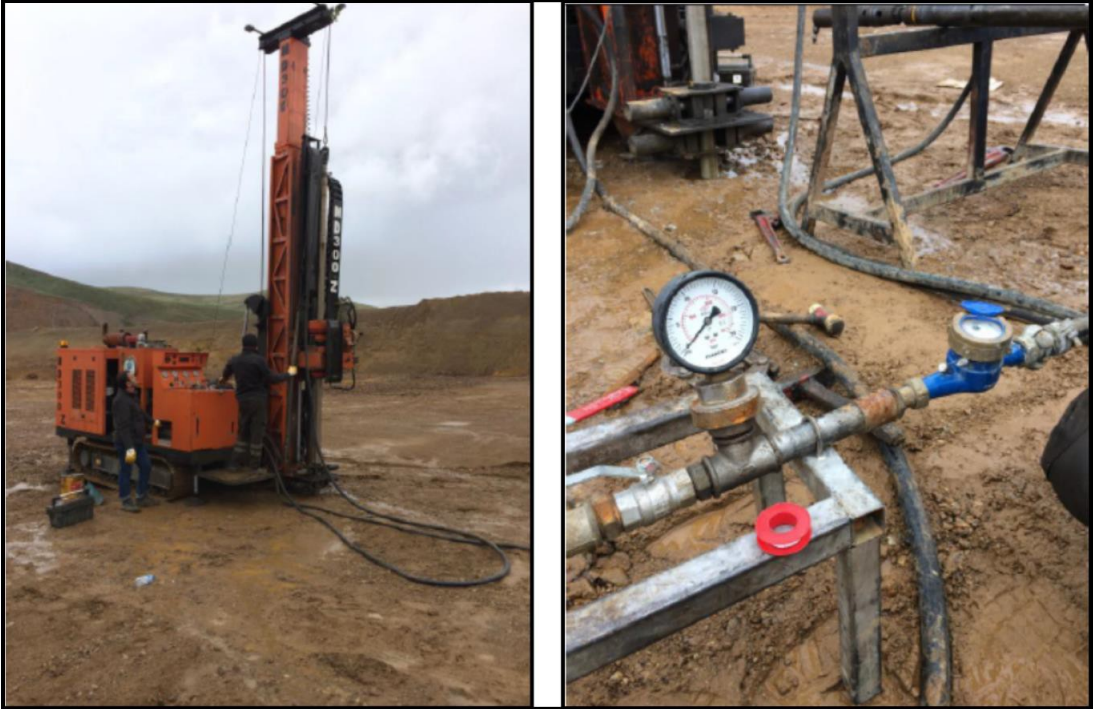
Şekil 2.18. Arazide sondaj ve BST deneyi
