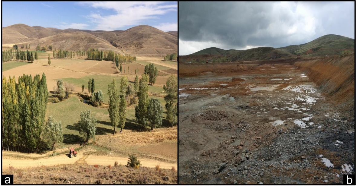
Şekil 4.2. Baraj eksen yerindeki (a) kazı öncesi (b) kazı sonrası çalışma alanı
