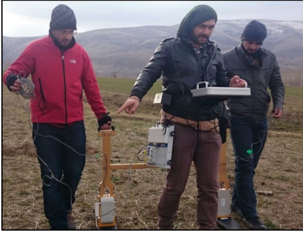
Şekil 4.93. GPR arazi çalışmaları ve 100 MHz korumasız anten düzeneği
