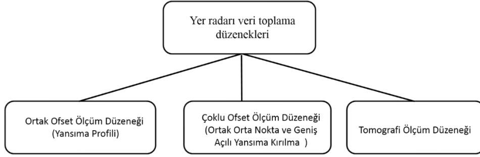
Şekil 1.11. Yer radarı yönteminde kullanılan ölçüm düzenekleri
