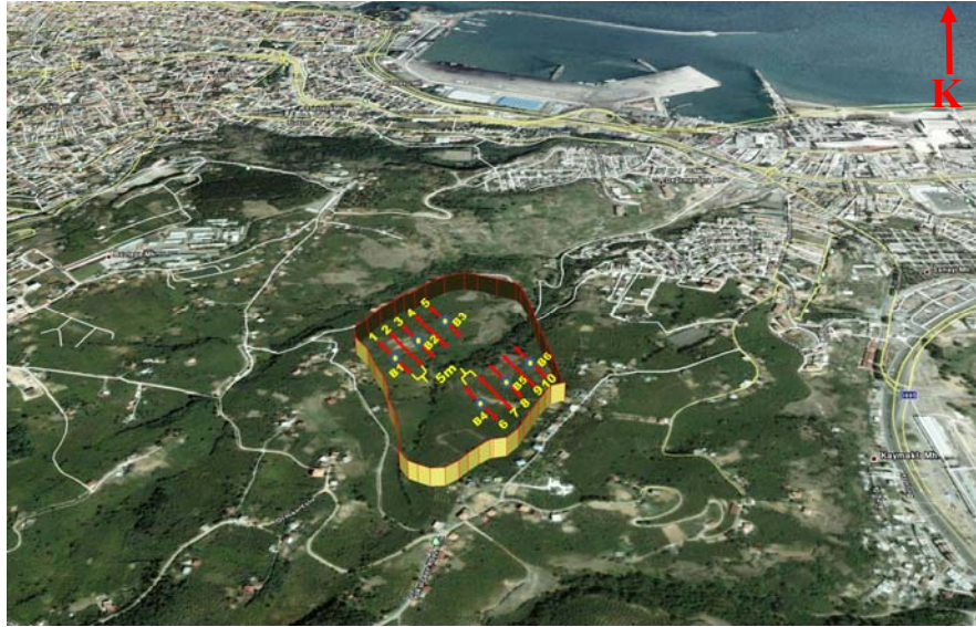
Şekil 61. Sismik ölçüm profilleri (1-10) ve sondaj noktaları (B1-B6)
