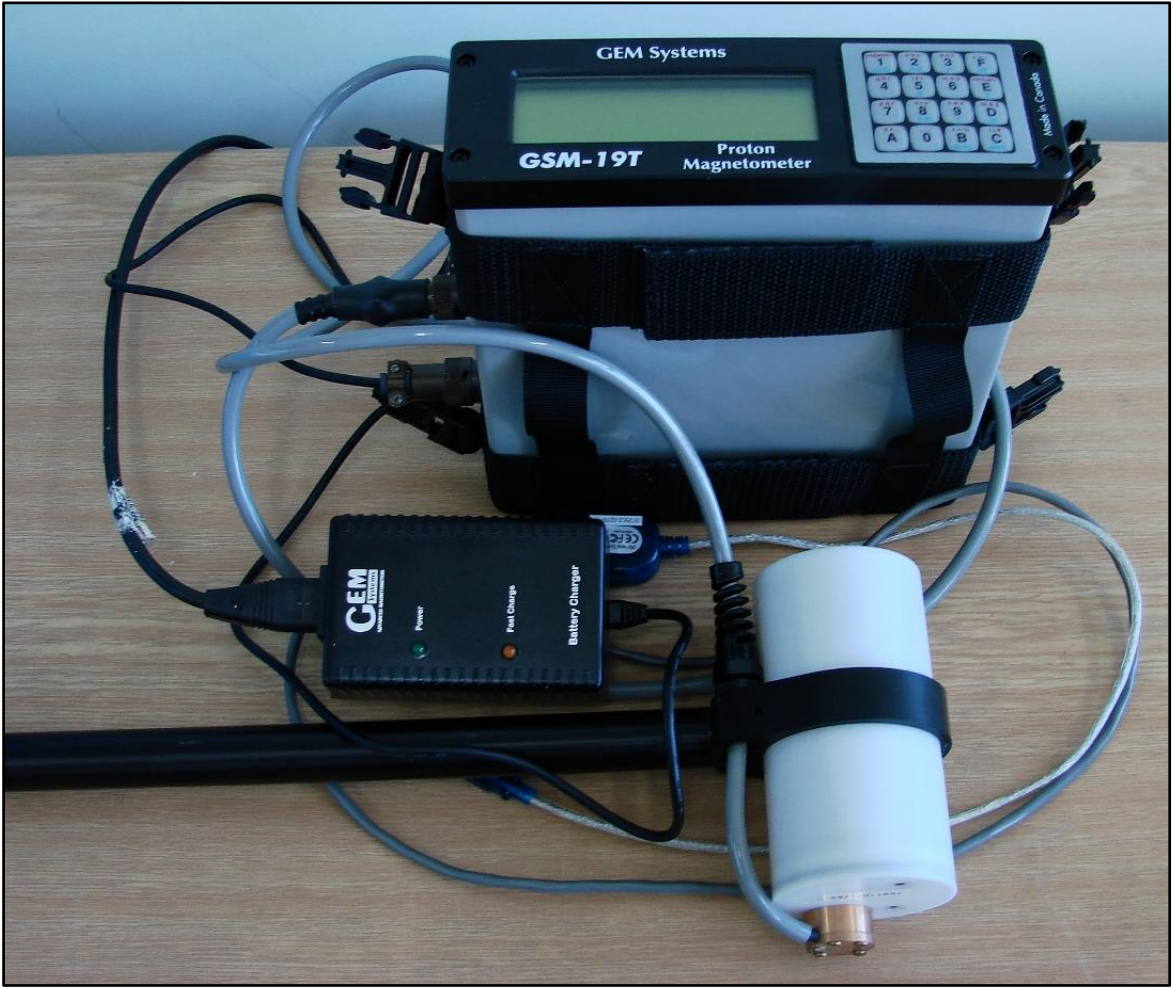
Şekil 11. Jeofizik Elektromanyetik Sistem Şirketinin (GEM Sistem, Kanada) GSM-19T tipi proton manyetometresi
