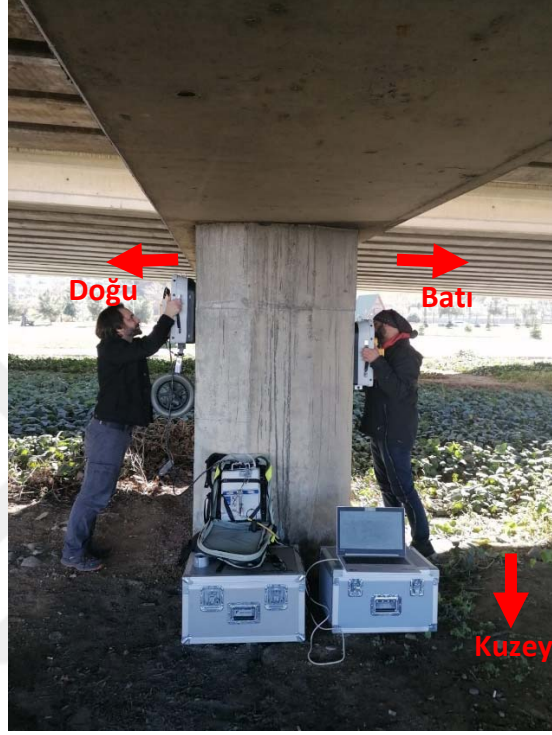
Şekil 55. Verici anten viyadük ayağının batı yüzünde belirlenen profil üzerindeki kayıt noktasında sabit tutulurken alıcı anten ile ayağın doğu yüzünde aynı profile karşılık gelen profil üzerinde ölçü alımı
