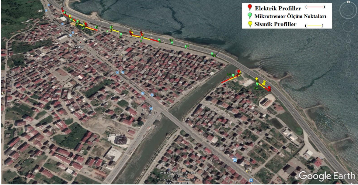
Şekil 4.5. Çalışma alanındaki sismik kırılma, elektrik özdirenc ve mikrotremor ölçüm noktaları (Google Earth,2018)
