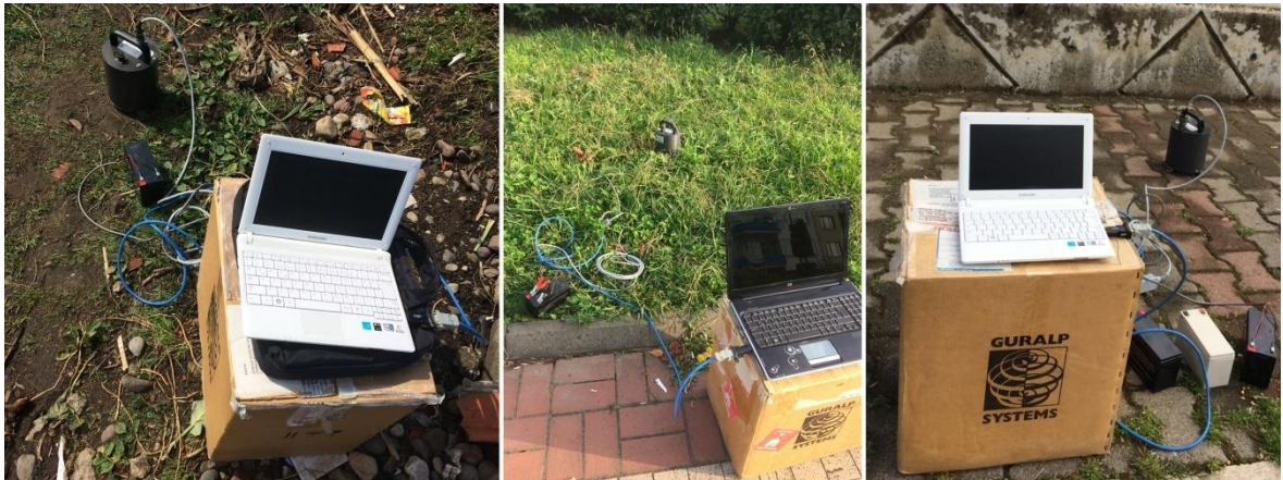
Şekil 4.23. Mikrotremor ölçüm ekipmanları
