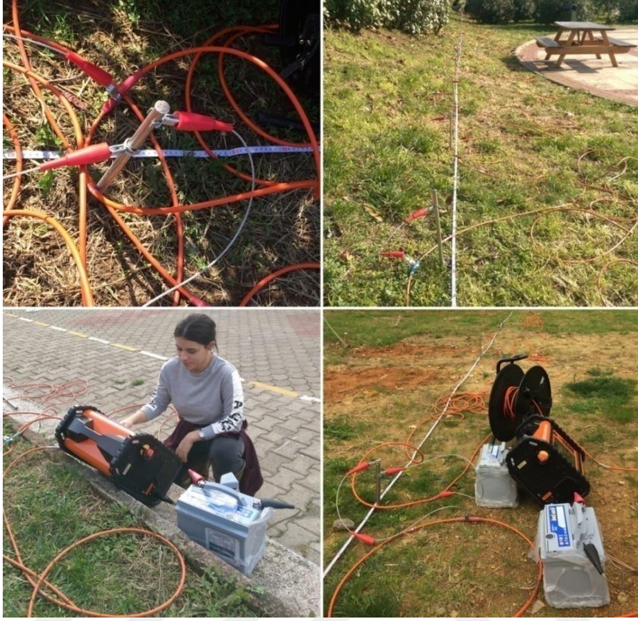
Şekil 4.16. ERT ölçüm ekipmanları ve profilleri
