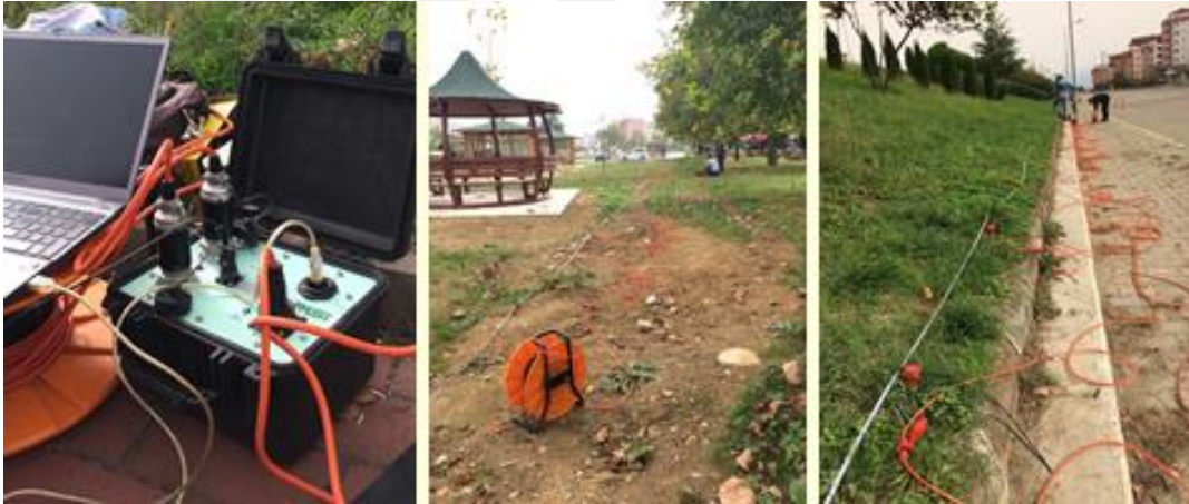
Şekil 4.7. Sismik ölçüm ekipmanı ve profil düzeneği görünümü
