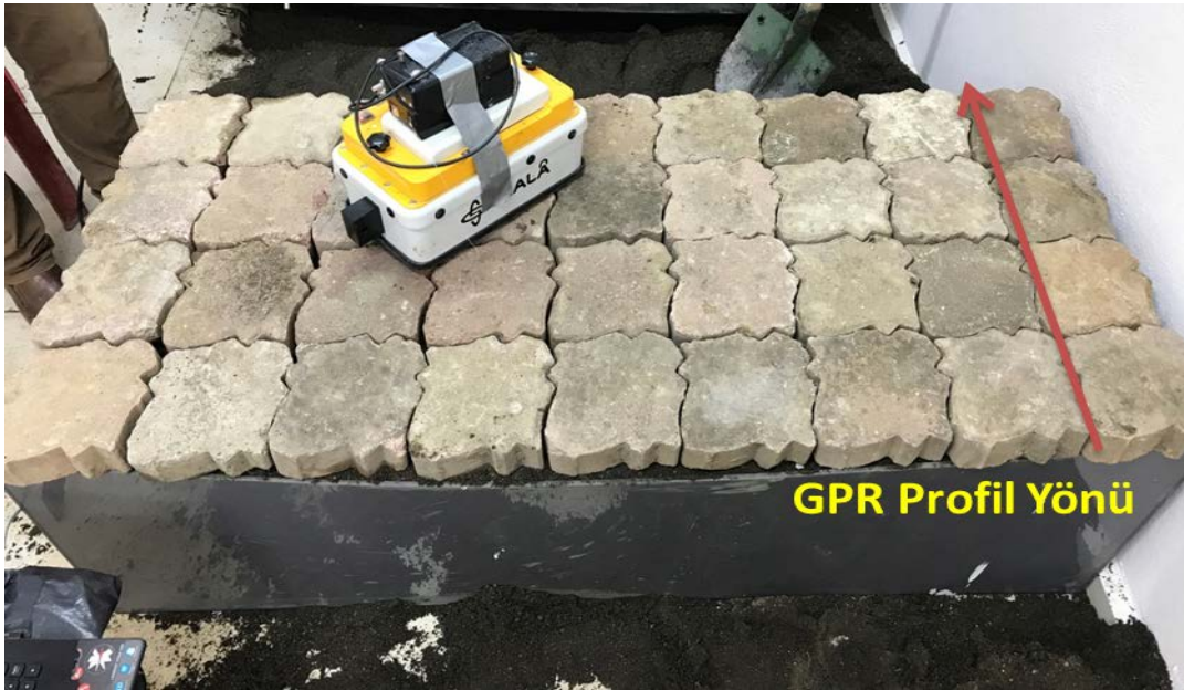
Şekil 3.30. İçi boş 125'lik PVC boru ile oluşturulan parke taşı kaplı laboratuvar model-8
