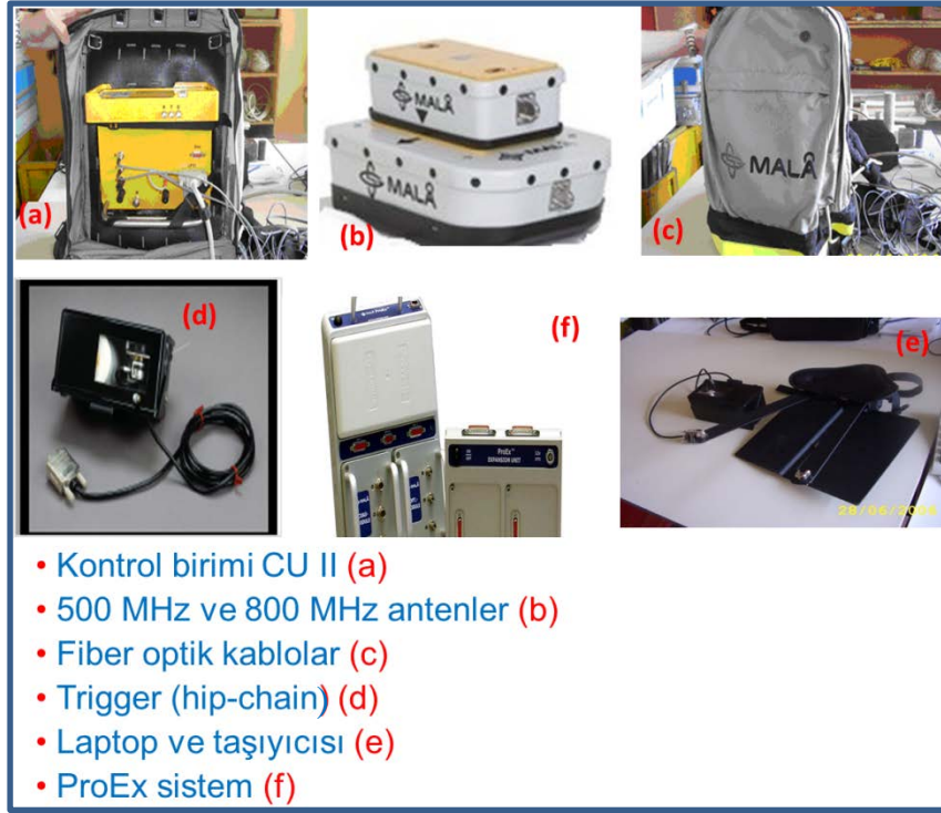
Şekil 2.5. GPR verilerinin toplanmasında kullanılan antenler ve sistemleri
