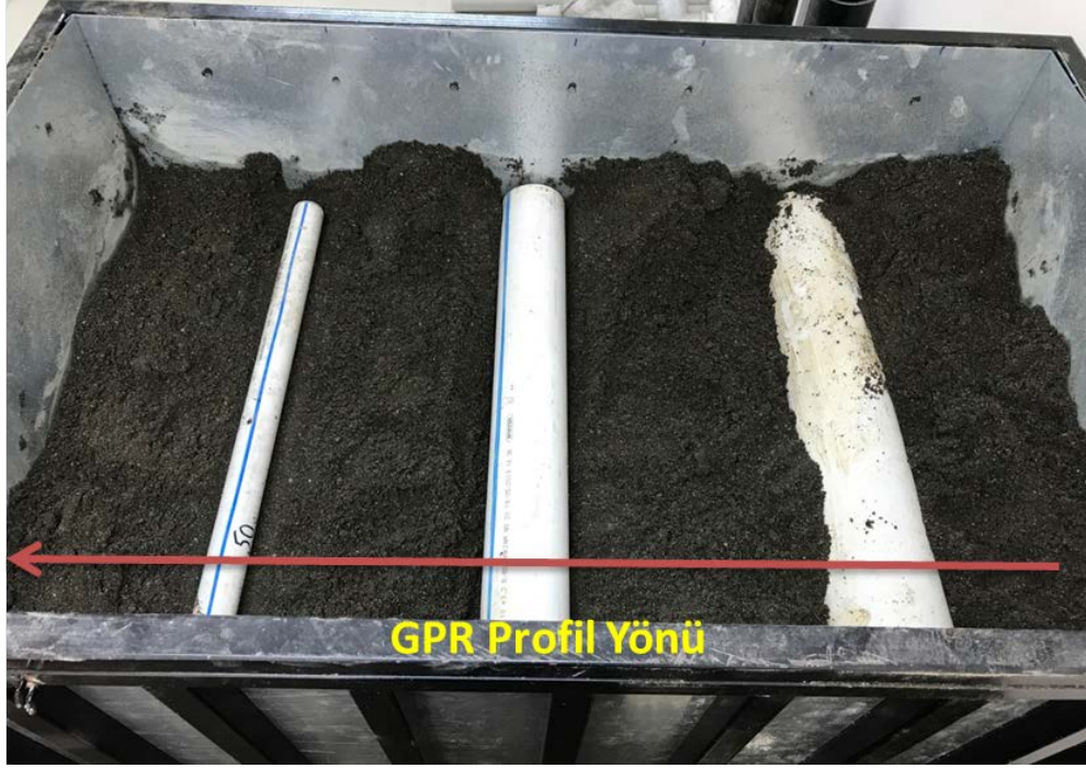
Şekil 3.12. Soldan sağa sırasıyla 50'lik, 100'lük ve 150'lik PVC borularla oluşturulan laboratuvar model-3
