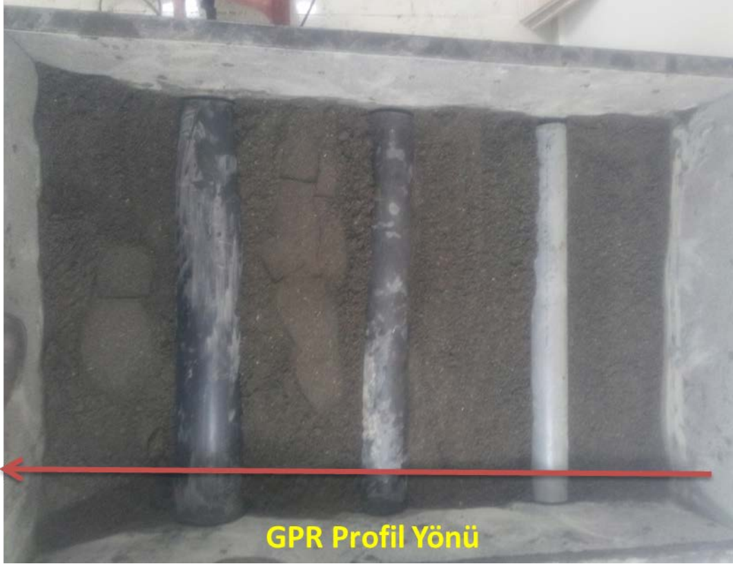
Şekil 3.16. Soldan sağa sırasıyla 150'lik, 100'lük ve 80'lik sert PVC borularla oluşturulan laboratuvar model-4
