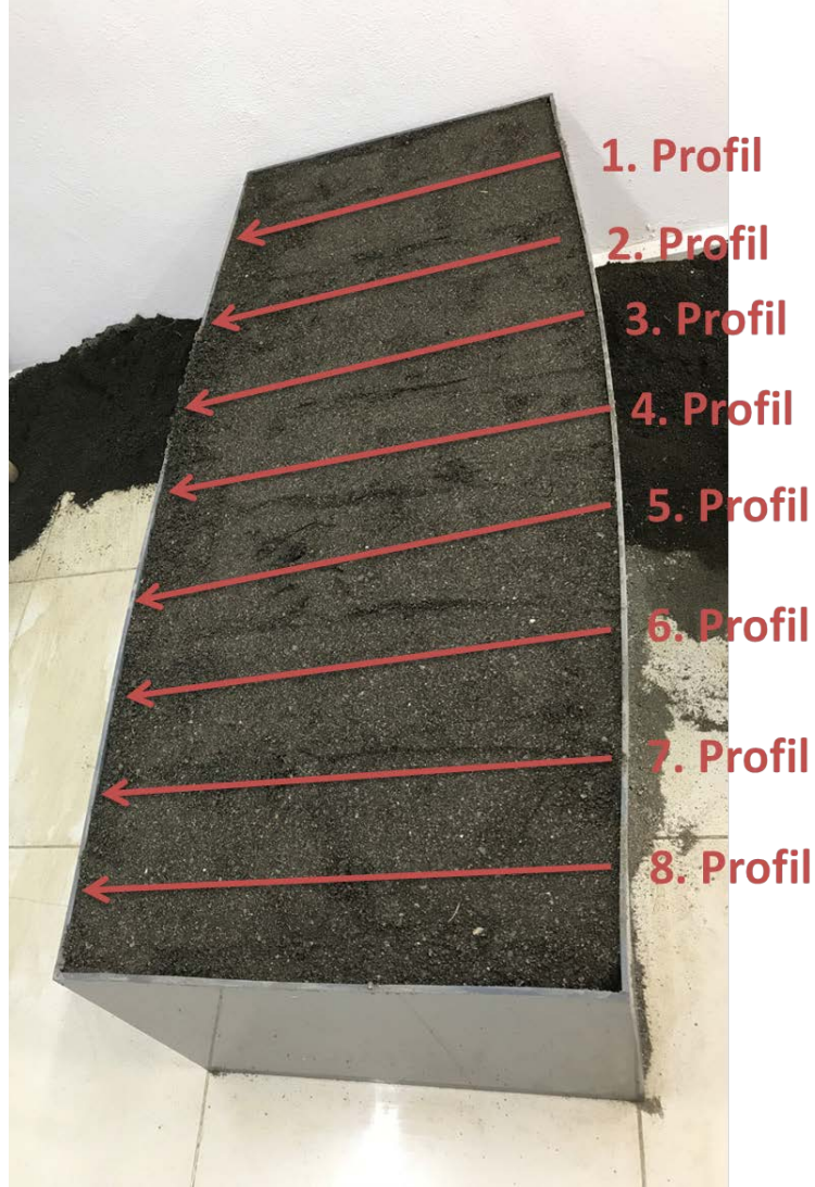
Şekil 3.2. Laboratuvar çalışmalarının yapıldığı plastik deney sandığında, 800 MHz anten ile GPR ölçümlerinin alındığı profiller
