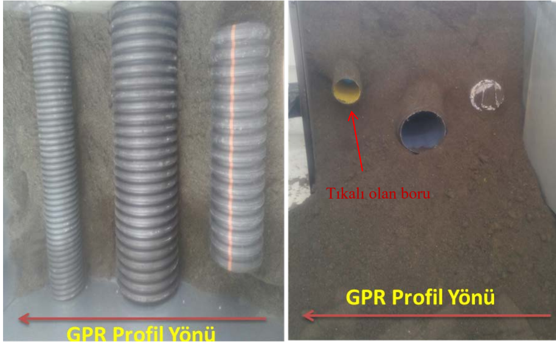
Şekil 3.4. Soldan sağa sırasıyla 150'lik, 300'lük ve 200'lük koruge borularla oluşturulan laboratuvar model-1
