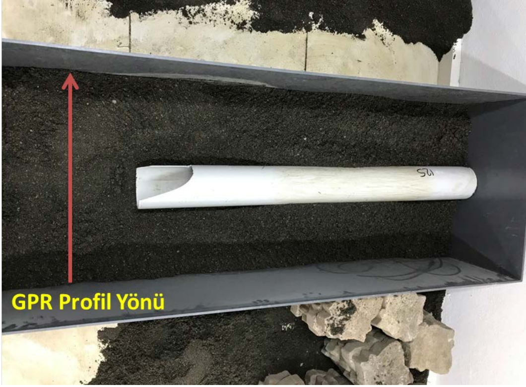
Şekil 3.27. İçi boş 125'lik PVC boru ile oluşturulan laboratuvar model-7
