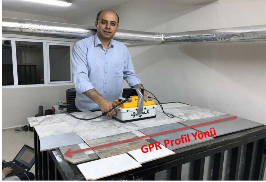
Şekil 3.8. Soldan sağa sırasıyla 150'lük, 300'lük ve 200'lük koruge borularla oluşturulan fayans kaplı laboratuvar model-2
