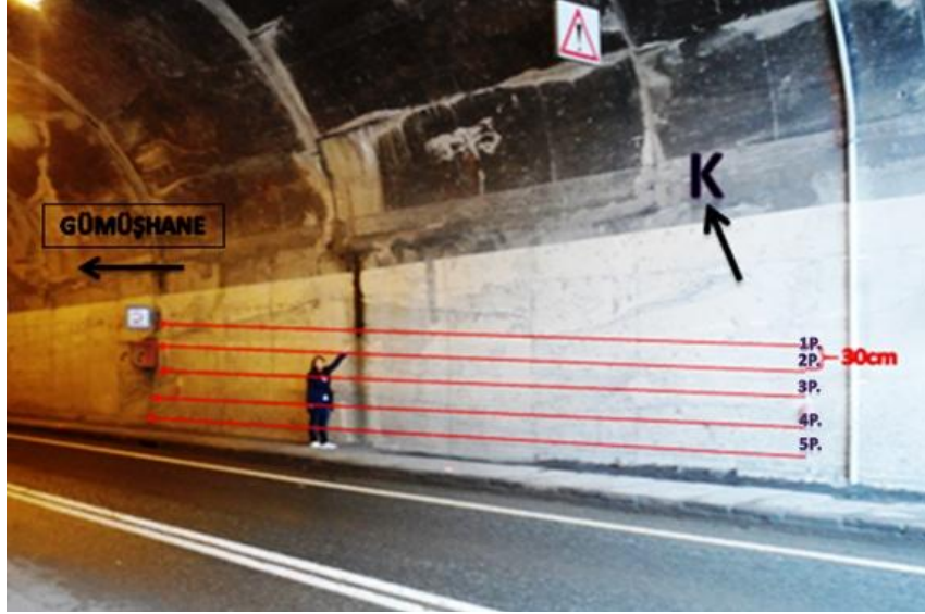
Şekil 2.8. Çalışma sahası 1 için GPR ölçü profilleri (Trabzon girişi)
