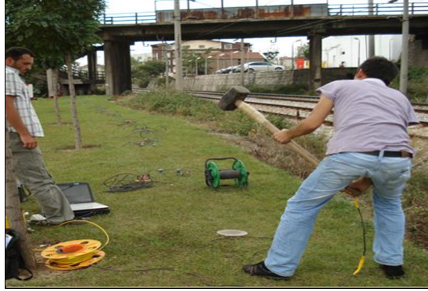
Şekil 1.1.Sismik kaynak ve jeofon dizilimi (URL-1,2013)
