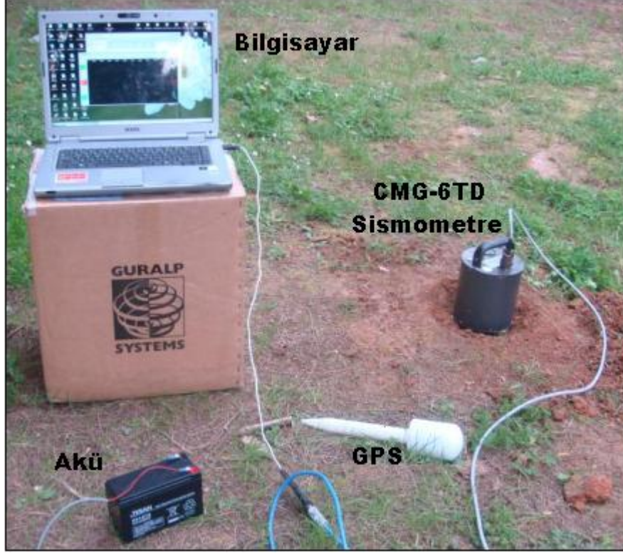
Şekil 28. Arazide mikrotremor kayıtlarının alınmasında kullanılan üç bileşen CMG-6TD hız ölçen sismometre, GPS, akü ve bilgisayar
