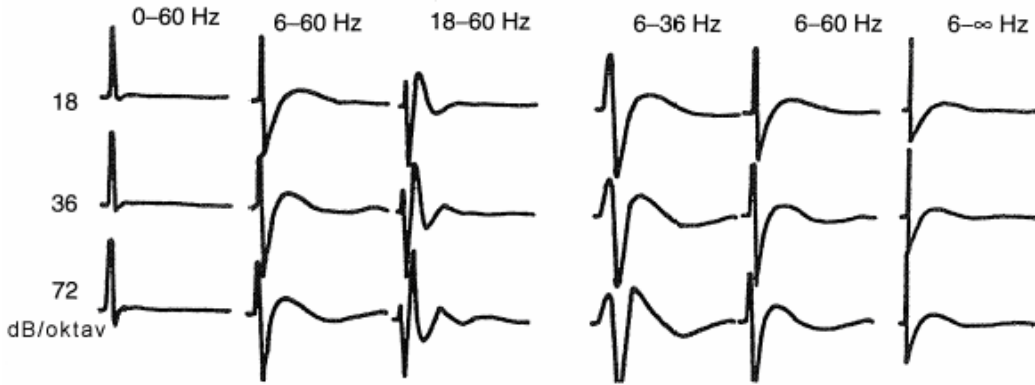
Şekil 1.8. Farklı süzgeç bant aralıklarının ve süzgeç eğimlerinin bir iđnecik sinyal üzerindeki karakteristik etkileri (Geldart ve Sheriff, 2004' den deđiřtirilerek alınmıřtır)
