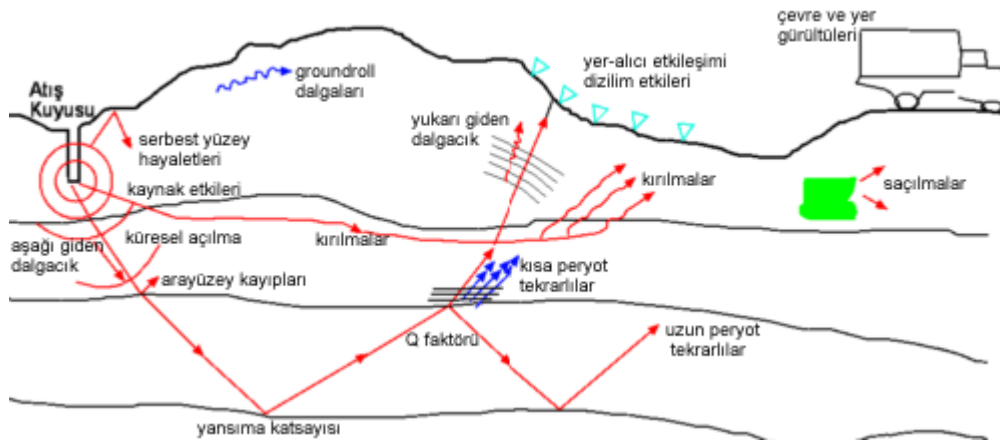
Şekil 1.5. Kaynaktan çıkan bir sismik dalgacığın, yeraltındaki hareketi boyunca maruz kaldığı faktörler (Reynold, 1997' den değiştirilerek alınmıştır).
