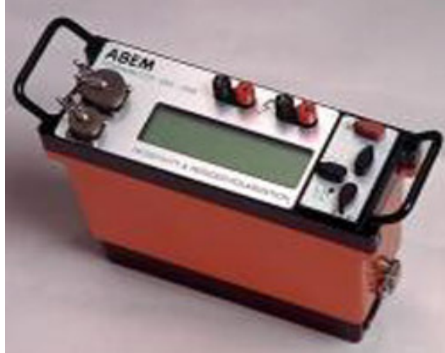
Şekil 13. ABEM TERRAMETER SAS 1000 Öz direnç ve IP aleti
