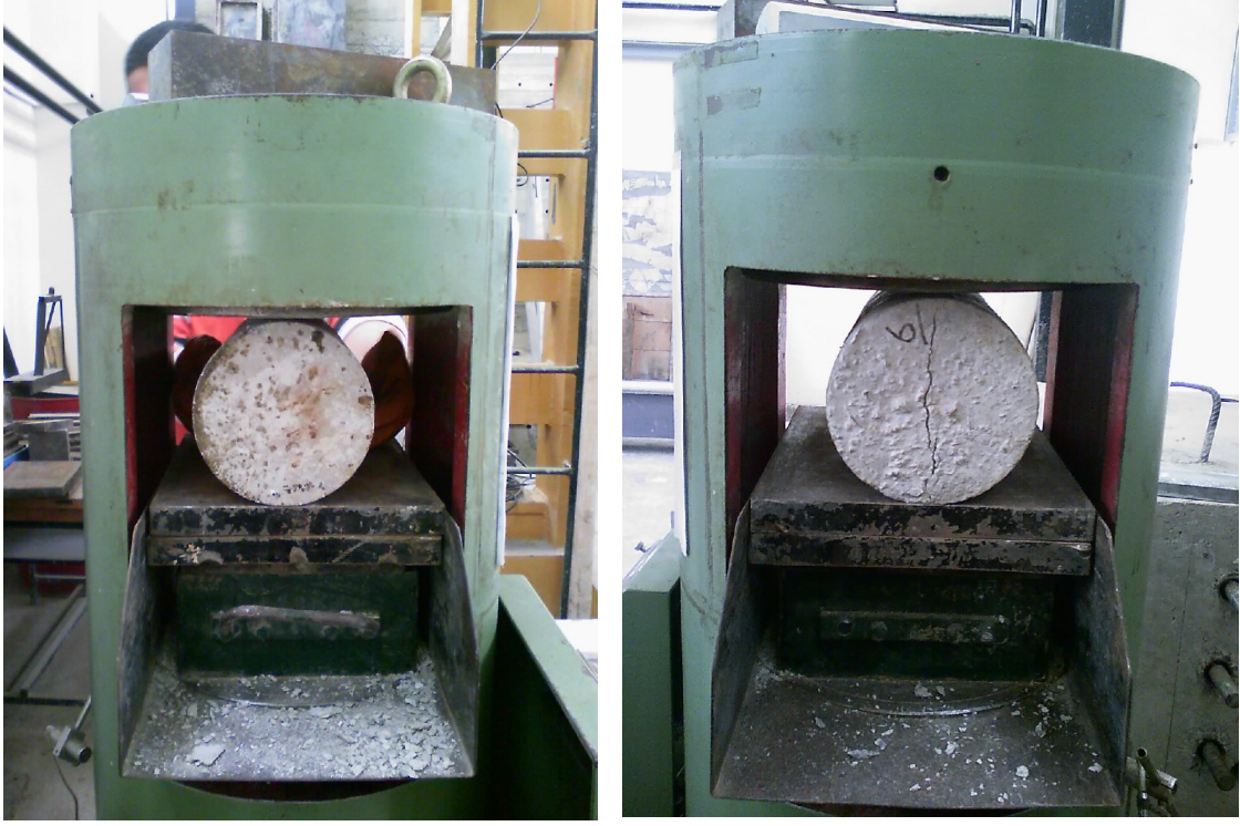
Şekil 26. Yarma deney düzeneğindeki numunenin deneyden önceki ve sonraki görünümü
