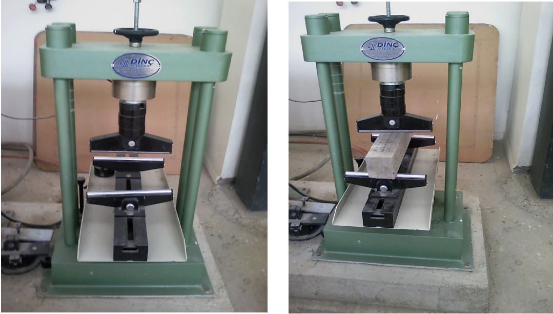
Şekil 27. Eğilme Dayanım deneyi için kullanılan ekipman
