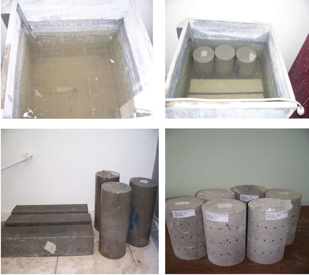
Şekil 5. Beton kür aşaması ve kür sonrası kuruma
