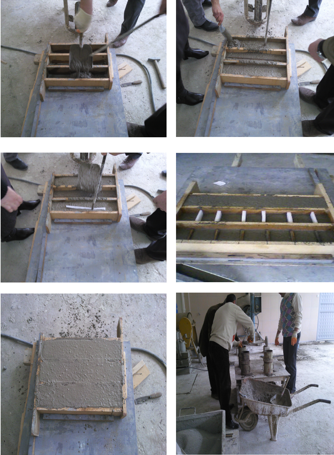
Şekil 4. Deney numunelerinin hazırlanma aşamaları
