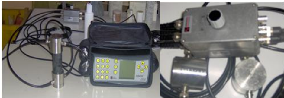
Şekil 20. Ultrasonik Hız Ölçmede Kullanılan Pundit Aleti
