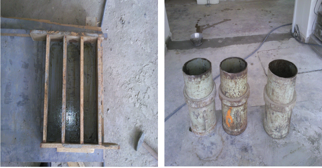
Şekil 2. Deney numune kalıpları
