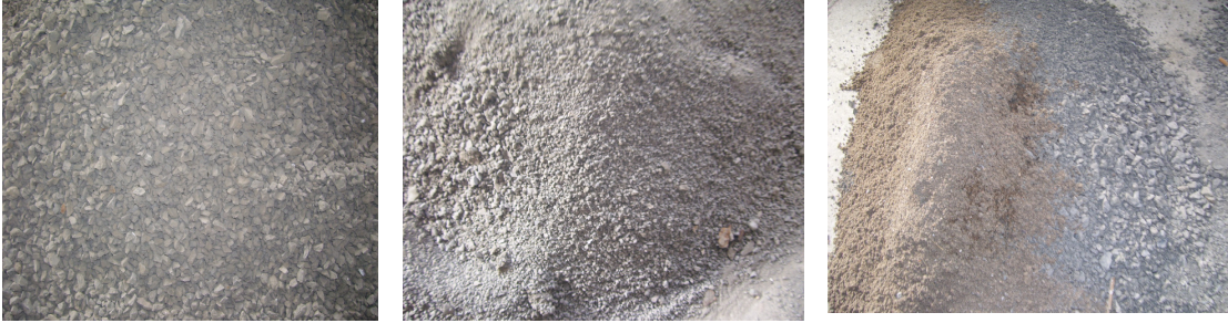
Şekil 1. Çalışmada kullanılan farklı boyutlardaki kalker agregası
