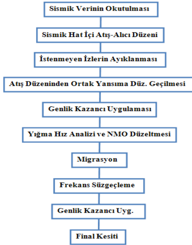
Şekil 71. Yansıma verilerine uygulanan veri işlem akış diyagramı.
