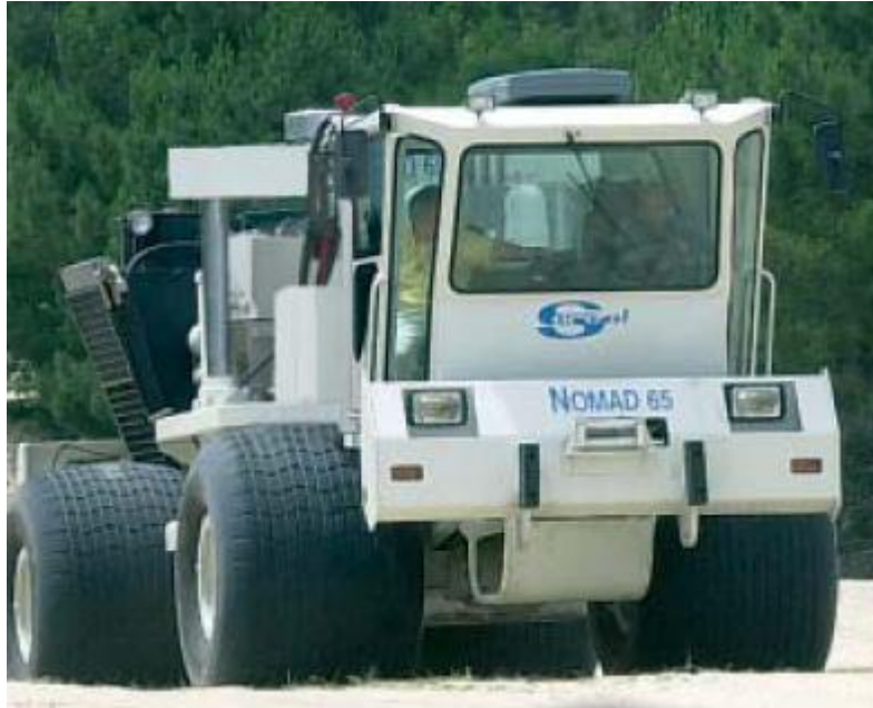
Şekil 15. Bir vibratörün önden ve soldan görünüşü (URL-1).
