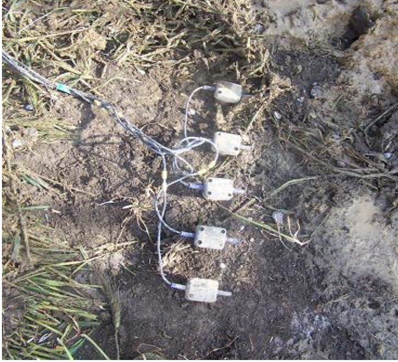
Şekil 22. Kuyu üstü atışlarda kullanılan alıcı dizilimi (TPAO).
