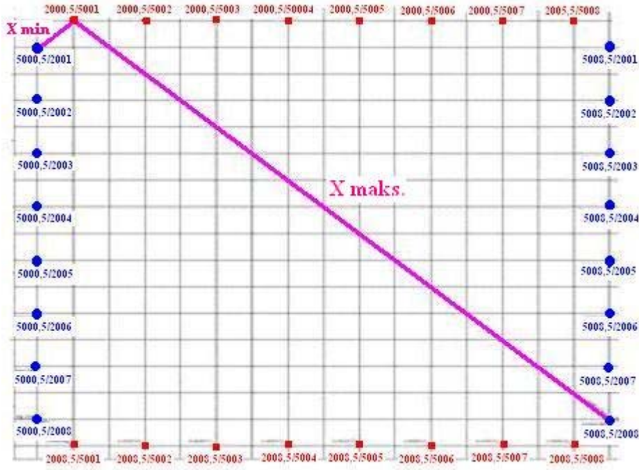
Şekil 31. Alıcı ve atış hatları, “ bin ” ve X_{min} mesafesini gösteren bir 3B kutusu.
