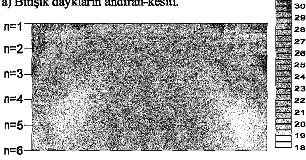
b) Bitişik 30 eğimli daykların andıran-kesiti.
