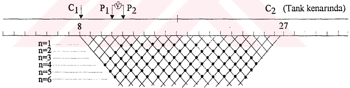
Şekil 24. Pol-dipol dizilimi ile ölçü alınan noktalar.
