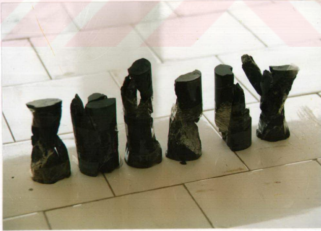
Şekil 20 Tek Eksenli Basınç Deneyi Sonunda Deney Örneklerinde Oluşan Kırılma Şekilleri.
