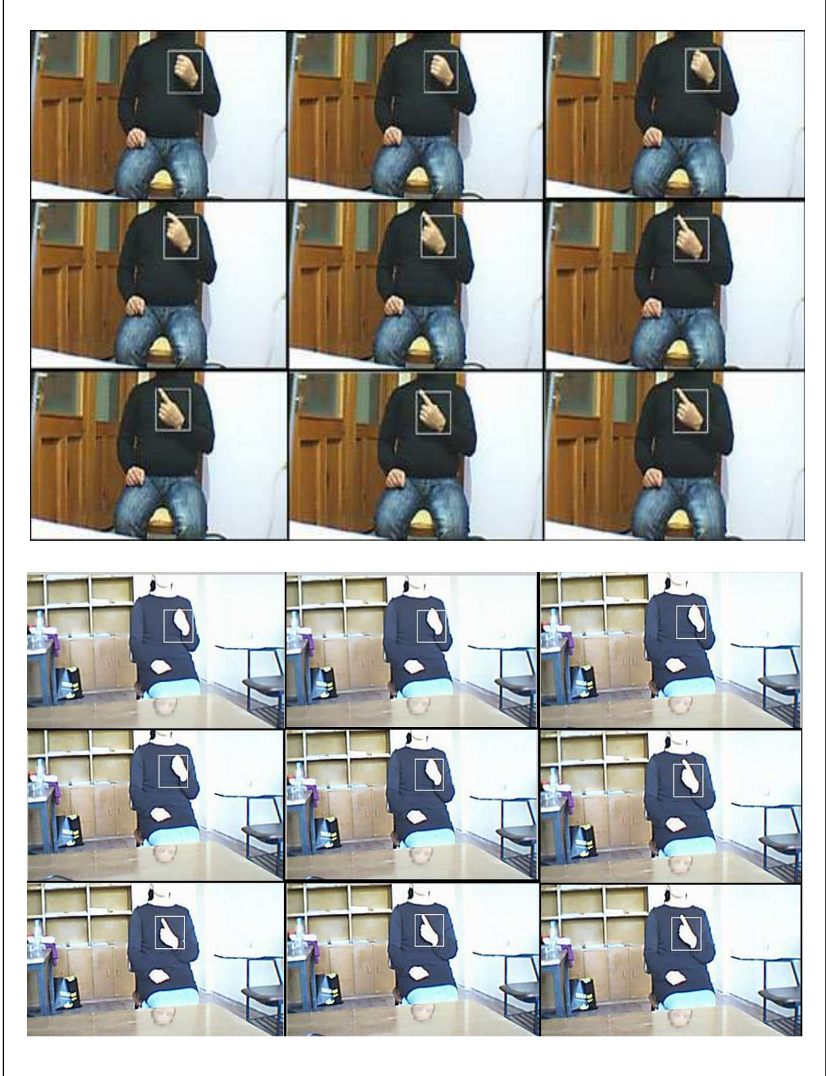
Şekil 2.3. Seçilen nesnenin ortalama kayma algoritmasına göre ilerleyen çerçevelerde takibini gösteren iki video örneği
