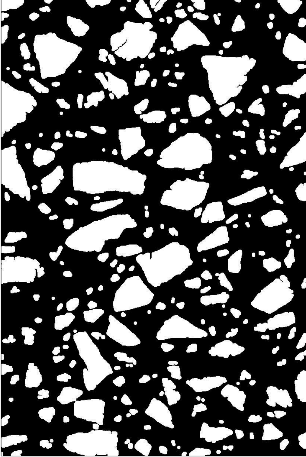
Şekil 30. Numune kesitindeki agregaların belirlenmesi
