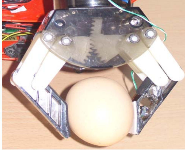
Şekil 2.6. Mikro anahtar yerleştirilmiş gripper(tutucu parmak) kısmı
