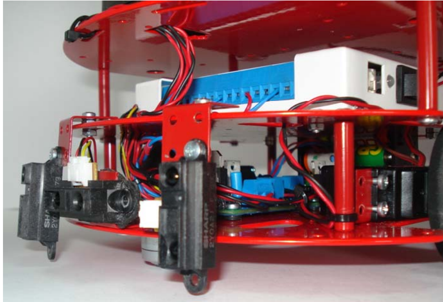
Şekil 2.4. Gezgin robotun ikinci katına monte edilen sensörler ve iBox
