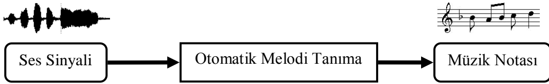
Şekil 18. Melodik ıslıkları notalara dönüştürme düzeneği
