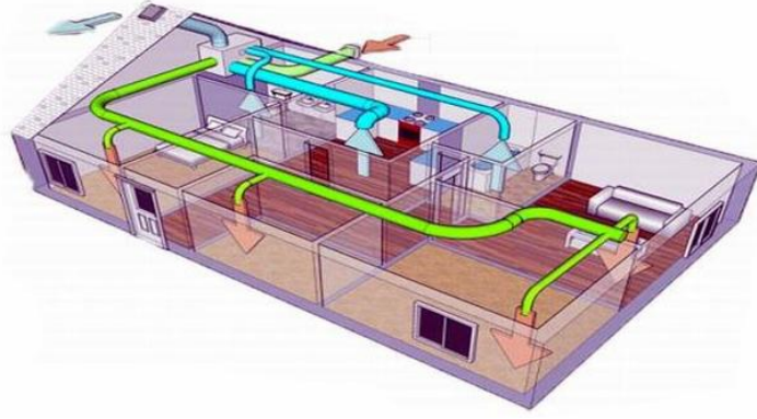
Şekil 20. Merkezi havalandırma sistemi (URL-21, 2021)
