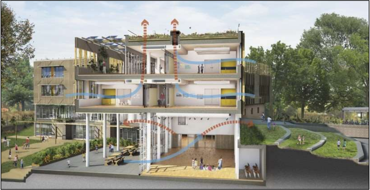
Şekil 24. Ashmount İlköğretim Okulu Pasif havalandırma sistemi (URL-25).
