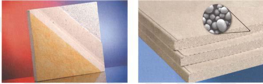
Şekil 55. Solda: Duvar yüzeyine uygulanan dekoratif FDM alçı sıva tabakası bileşimi, sağda: Sadece 15 mm kalınlığında olmasına rağmen bu alçıpan levha metrekare başına 3 kg mikrokapsüllü gizli ısı depolama malzemesi içermektedir (Leydecker, 2008).
