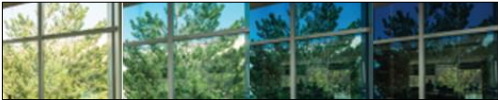
Şekil 32. Elektrokromik camın renk değiştirmesi (URL-22, 2018)
