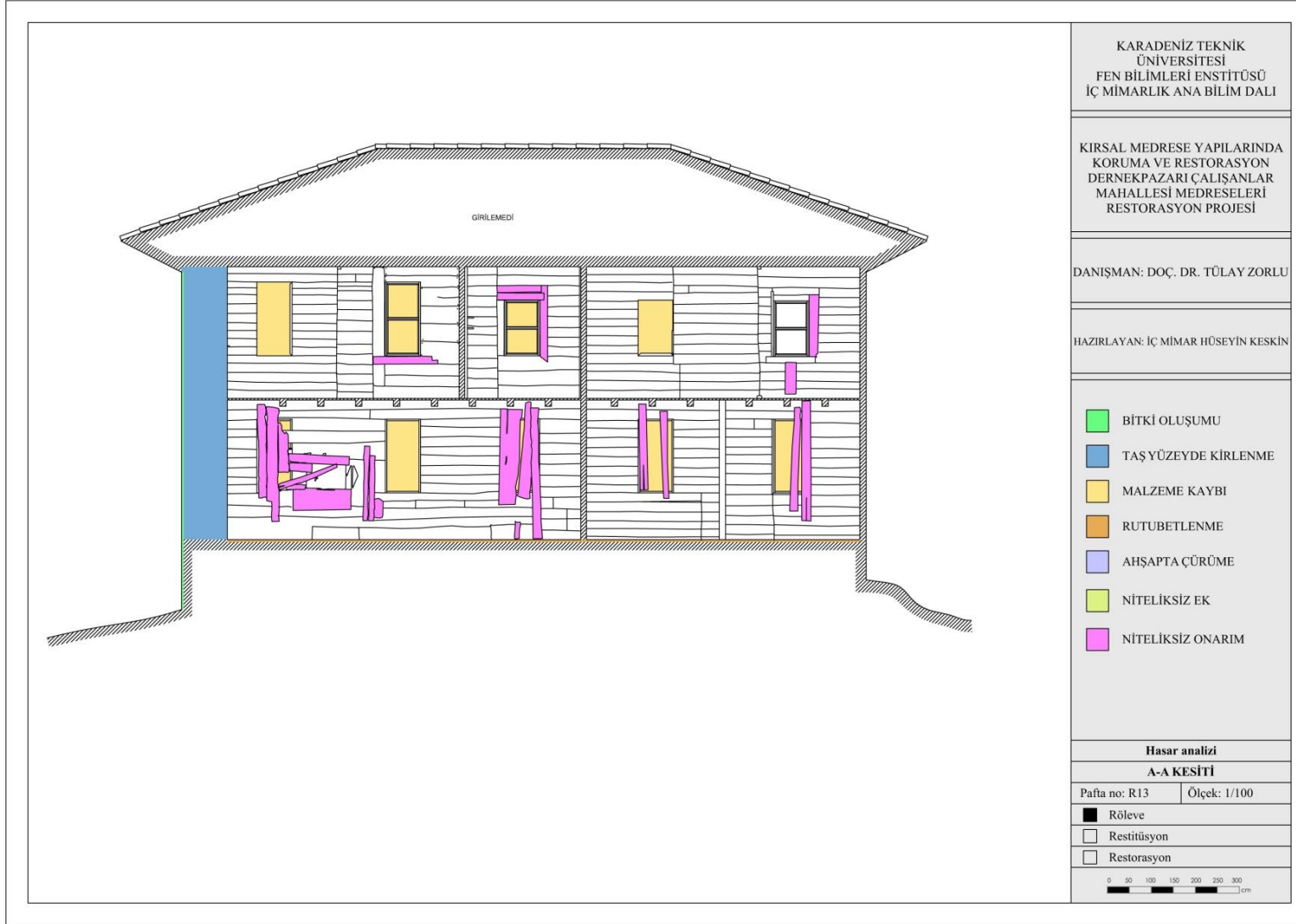
Ek 70. Rüştüye Yapısı A-A Kesiti Hasar Analizi (Hazırlayan: Hüseyin KESKİN)
