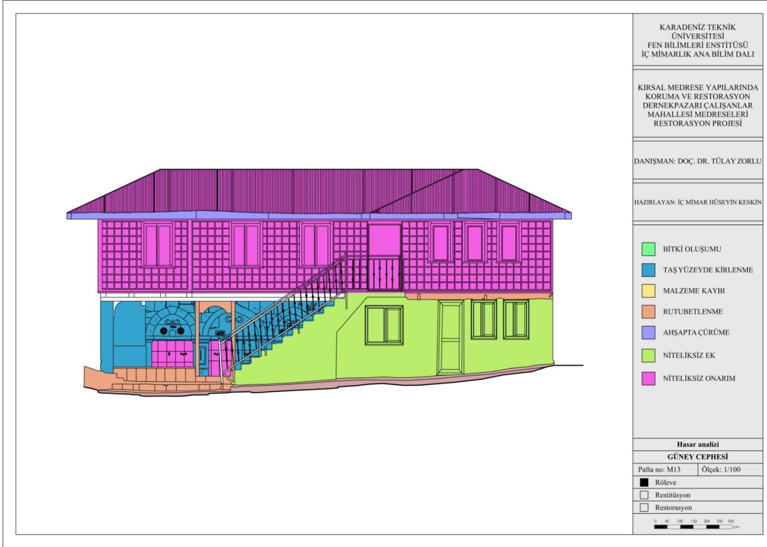
Ek 22. Medrese Yapısı Güney Cephesi Hasar Analizi (Hazırlayan: Hüseyin KESKİN)
