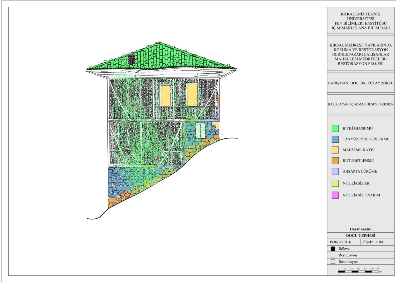
Ek 73. Rüştüye Yapısı Doğu Cephesi Hasar Analizi (Hazırlayan: Hüseyin KESKİN)
