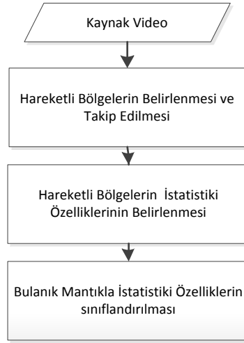
Şekil 2.1 Sistemin Genel Yapısı.
