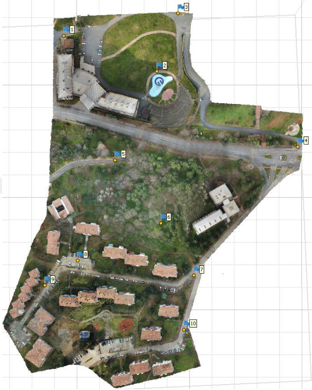
Şekil 29. Uygulama Sahasının Yüzey ağı Modeli ve Yer Kontrol Noktaları
