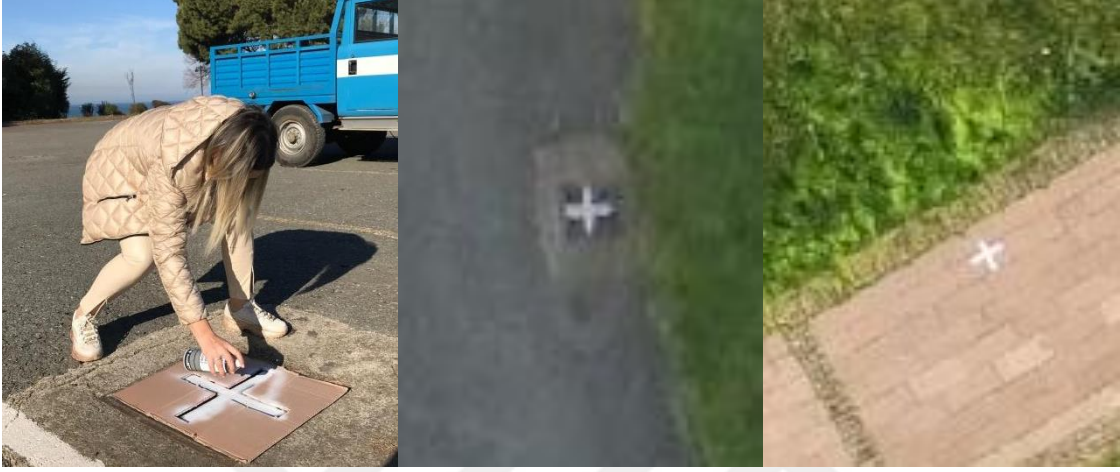
Şekil 18. Yer Kontrol Noktalarının ve Test Noktalarının Tesisi ve Hava Fotoğraflarındaki Görünümü
