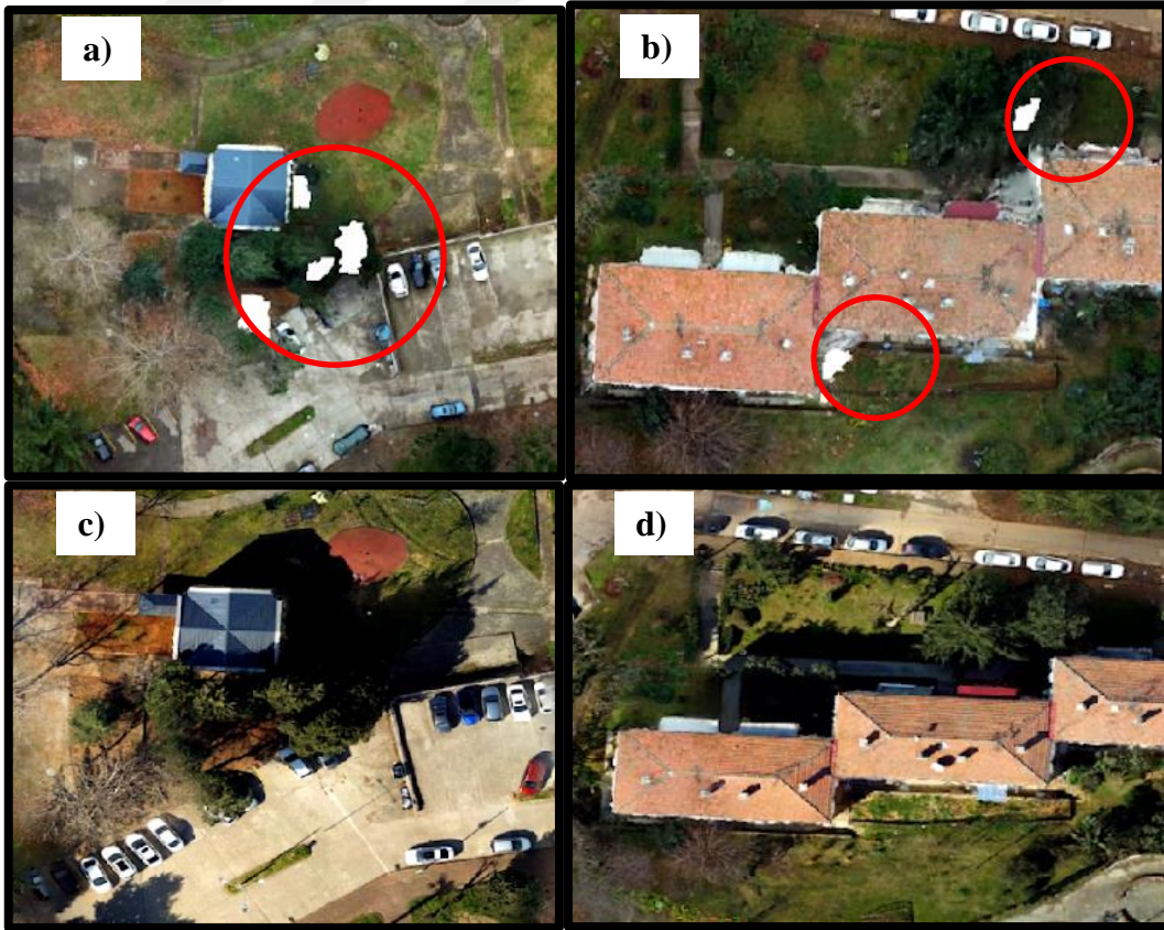
Şekil 45. İlk Üretilen Ortofoto Haritasındaki Açıklıklar ve Çözüm Sonrası Görünümü
