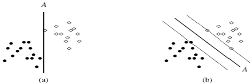
Şekil 1.32. İki adet doğrusal ayrılabilen veri kümesi. (a) Rastgele seçilmiş ayırma düzlemi (b) En büyük marjini verecek ayırma düzlemi
