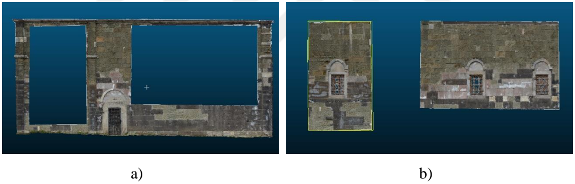
Şekil 56. Nokta bulutundan alan kesme işlemi; a) Ana nokta bulutundan kesilen alanlar ve b) Çevrilen alan içinde kalan nokta bulutu verilerinin çıkartılması
