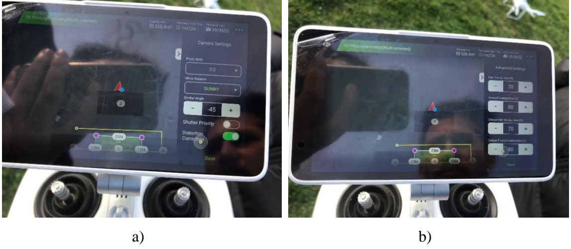
Şekil 38. DJI Photogrammetry yazılımında uçuş parametrelerinin girilmesi; a) Kamera açısının belirlenmesi b) Görüntü bindirme oranının belirlenmesi
