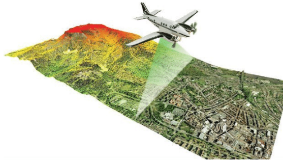
Şekil 3. Hava lazer tarama yöntemi (URL-2)
