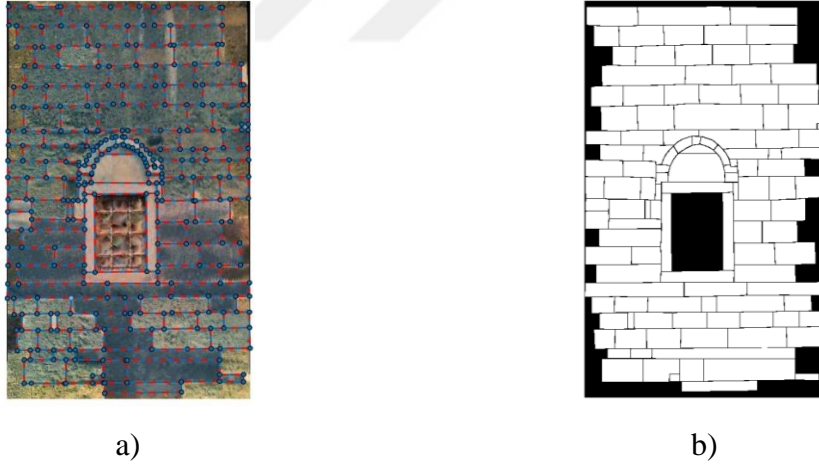
Şekil 90. Cephe 1 Alan 2'ye ait; a) vektör veri ve b) bu veriden üretilmiş maske
