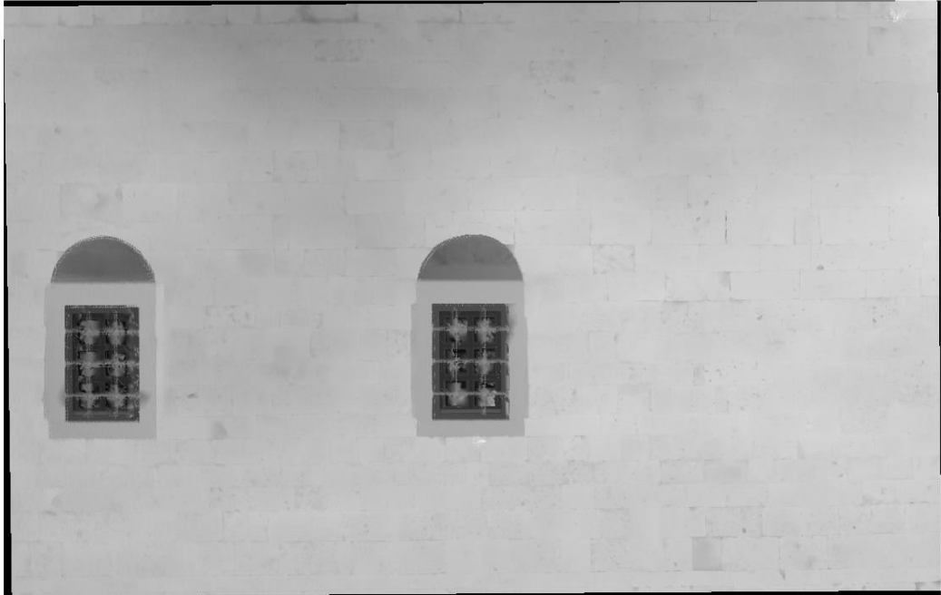
Şekil 66. Faro Focus3D X130 ile elde edilmiş Cephe 3 Alan 1'e ait nokta bulutunun raster derinlik görüntüsü
