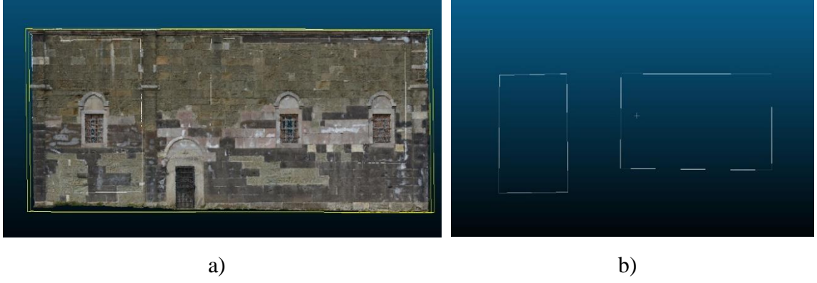
Şekil 55. Nokta bulutundan alan kesme işlemi; a) Nokta bulutu verisinin aktarılması b) Nokta bulutundan kesilecek alanların çizilmesi
