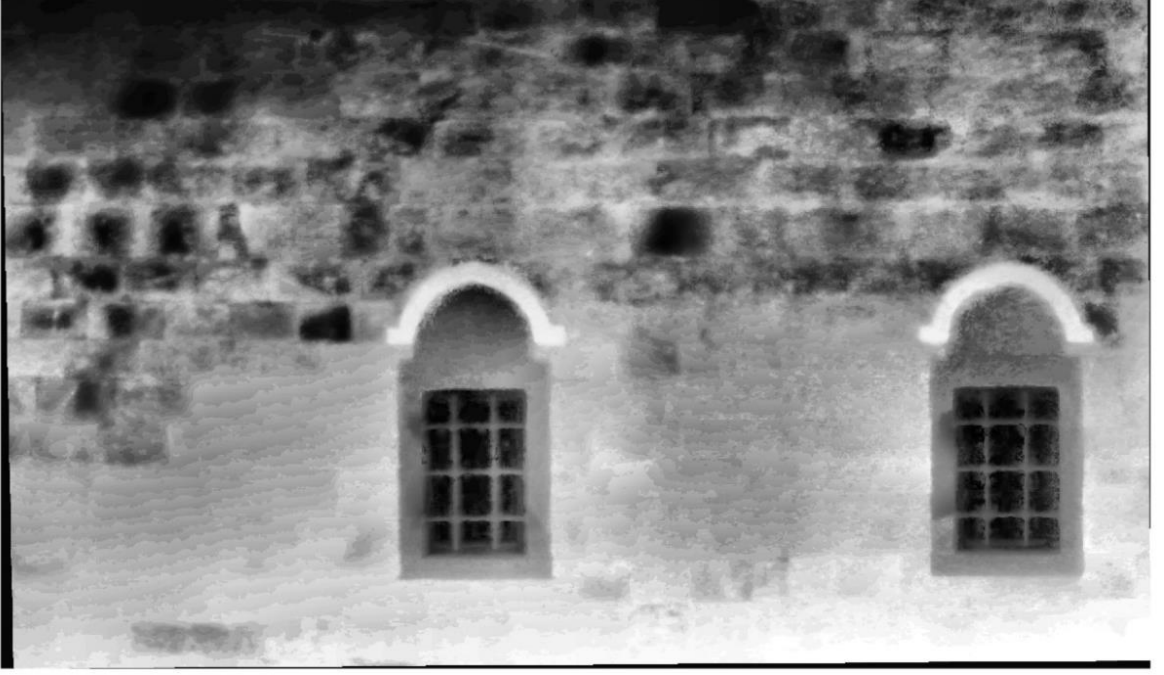
Şekil 71. Nikon D3200 ile elde edilmiş Cephe 1 Alan 1'e ait nokta bulutu raster derinlik görüntüsünün histogram eşitleme sonucu oluşan görüntü
