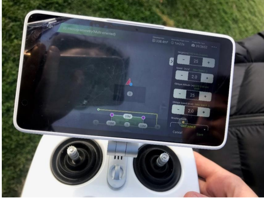
Şekil 37. Drone kumanda ekranından uçuş alanı ve yüksekliğinin seçimi
