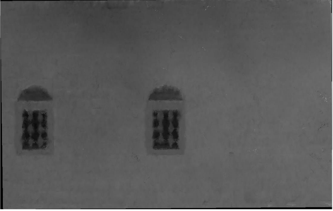
Şekil 65. DJI Phantom 4 RTK ile elde edilmiş Cephe 3 Alan 1'e ait nokta bulutunun raster derinlik görüntüsü
