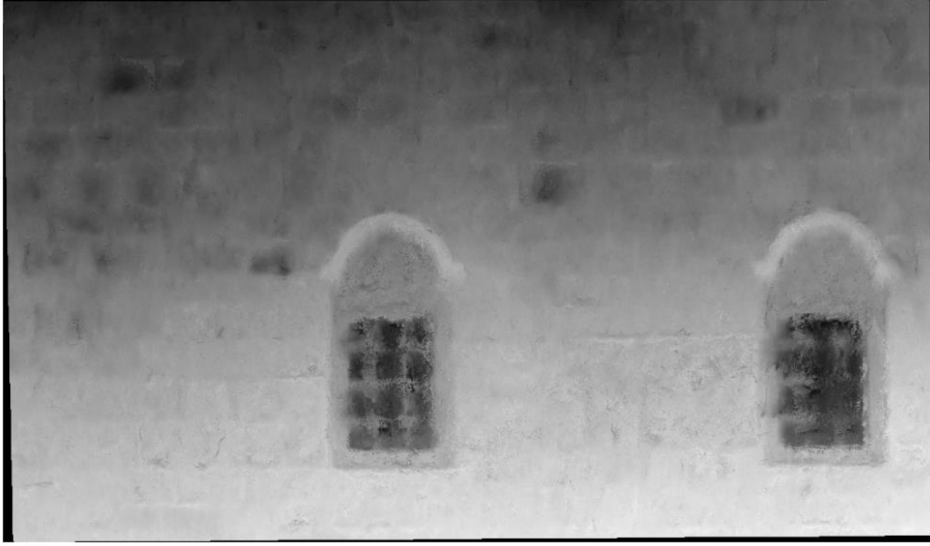
Şekil 59. DJI Phantom 4 RTK ile elde edilmiş Cephe 1 Alan 1'e ait nokta bulutunun raster derinlik görüntüsü
