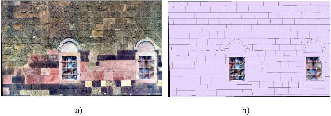
Şekil 58. Referans Verilerin Üretilmesi a) Raster görüntünün aktarılması b) Raster görüntüden manuel alan çevirme işlemi
