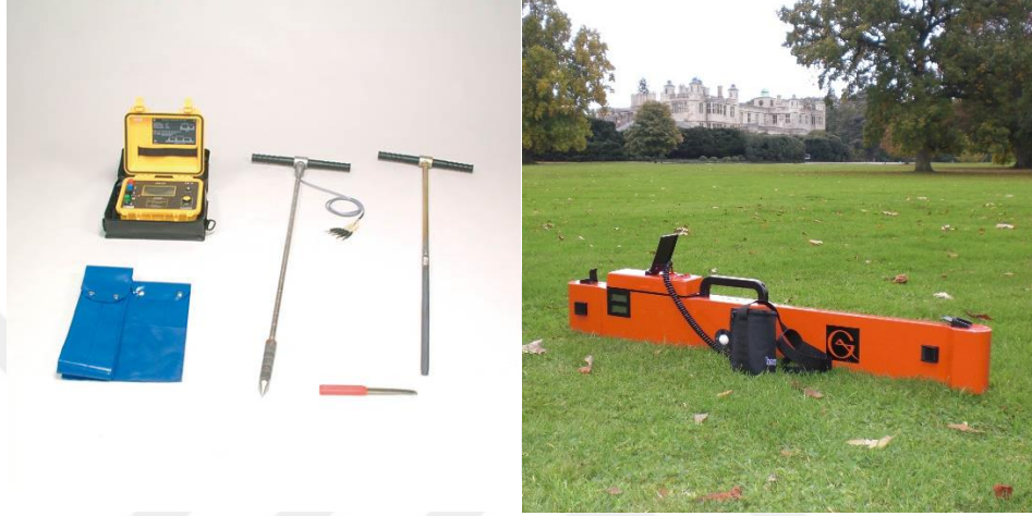
Şekil 1. EC-Probe ve EM-38 Tuz Ölçüm Cihazı (URL-1 ve URL-2)
