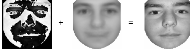
Şekil 70. Giriş resminin özyüz uzayına tüm özvektörlerle taşındıktan sonra tekrar elde edilmesi
