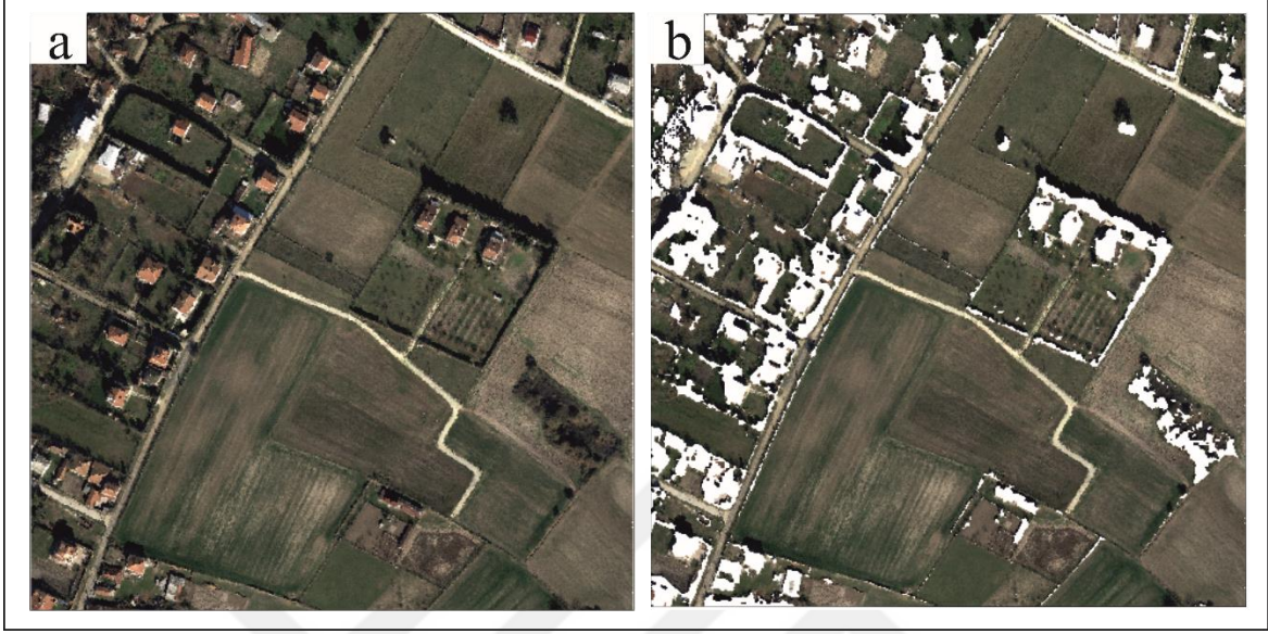
Şekil 12. Zemin detayı çıkarılmış nokta bulutu verisi; a) nokta bulutu b) zemin detayı çıkarıldığı nokta bulutu
