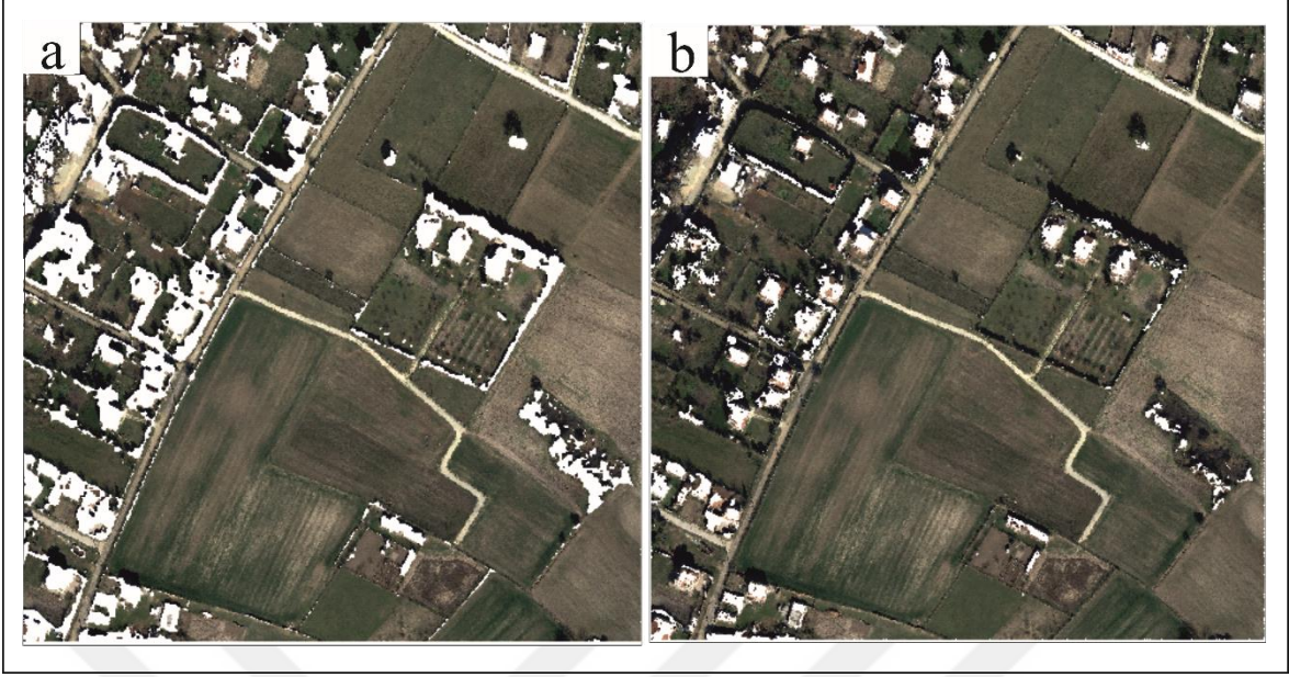
Şekil 14. Bina detayı çıkarılmış nokta bulutu verisi; a) yer üstü nokta sınıflarının çıkarıldığı nokta bulutu b) bina sınıfının çıkarıldığı nokta bulutu
