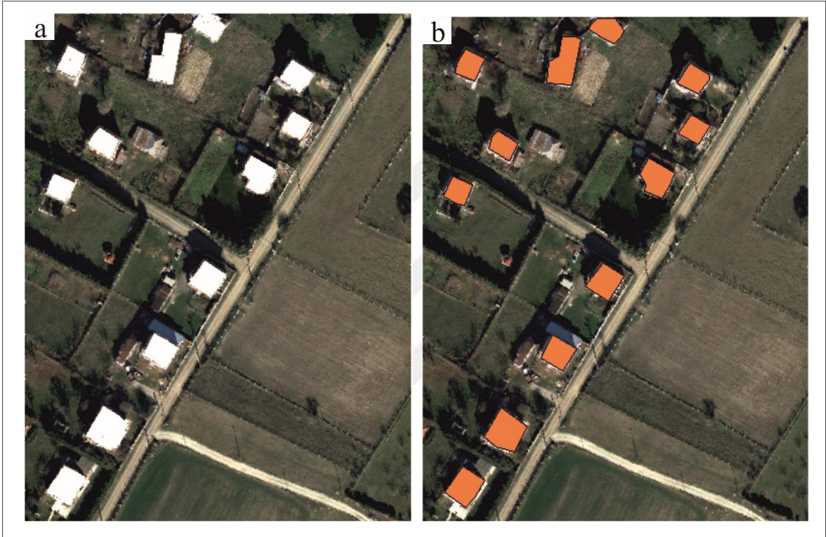
Şekil 16. Otomatik olarak örnek veri alanında çizilmiş 2B bina sınırları; a) bina sınıfı tamamen çıkarılmış nokta bulutu b) bina detayı otomatik çıkarılmış nokta bulutu
