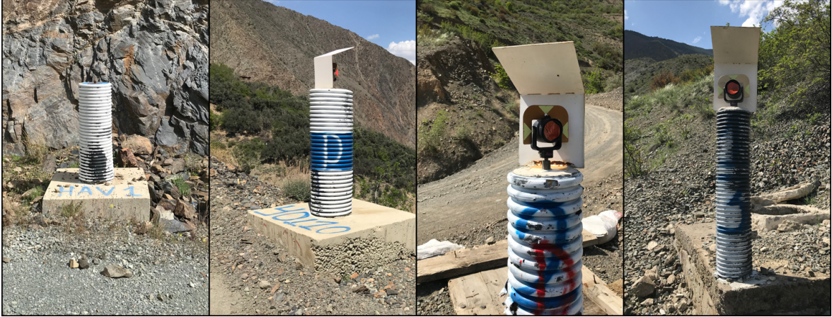
Şekil 29. Araziye tesis edilmiş ölçüm noktaları. Soldan sağa doğru sırasıyla H-1, H-2, DEF-2 ve DEF-13
