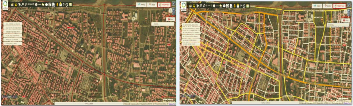
Şekil 25. Yol orta hatlarının oluşturulması
