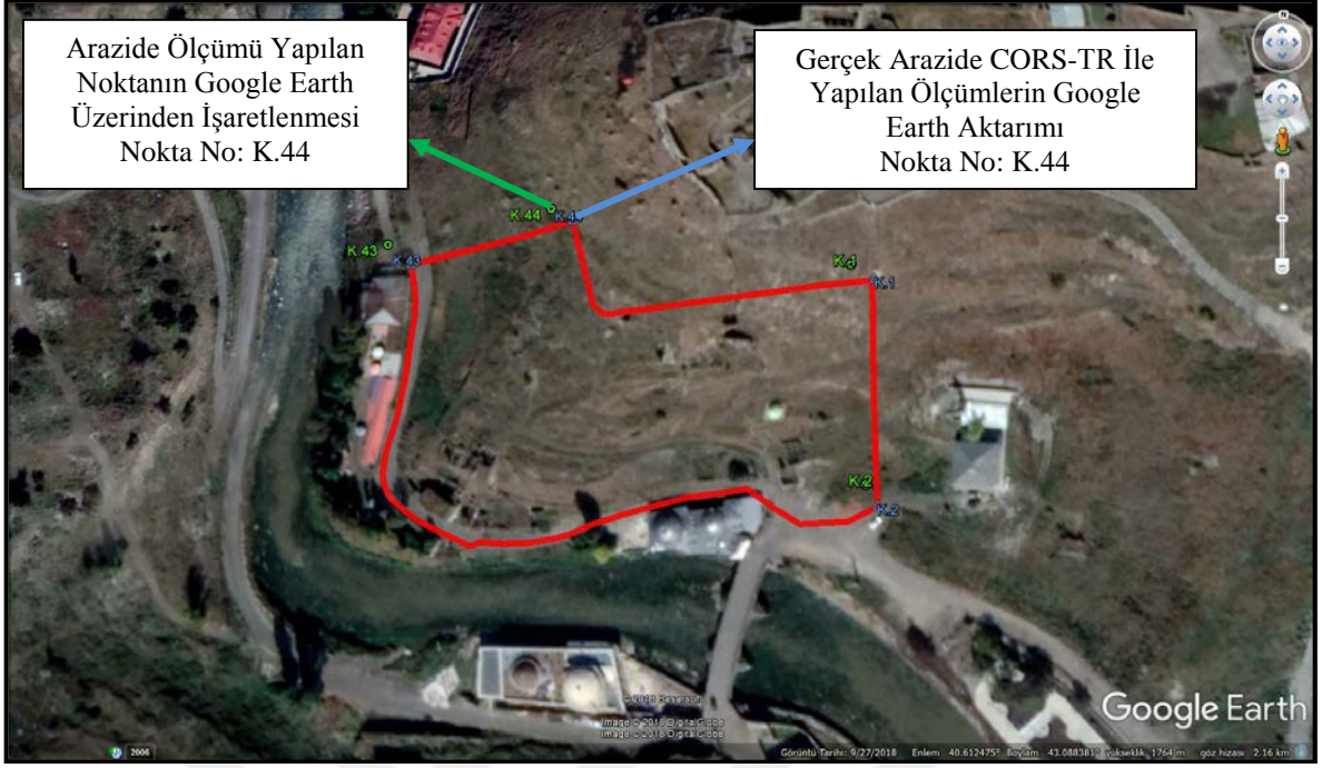
Şekil 80. Merkez kaya düşmesi gerçek ölçüm değerleri ile arazide google earth üzerine işaretlenen 4 noktanın google earth ortamında karşılaştırılması
