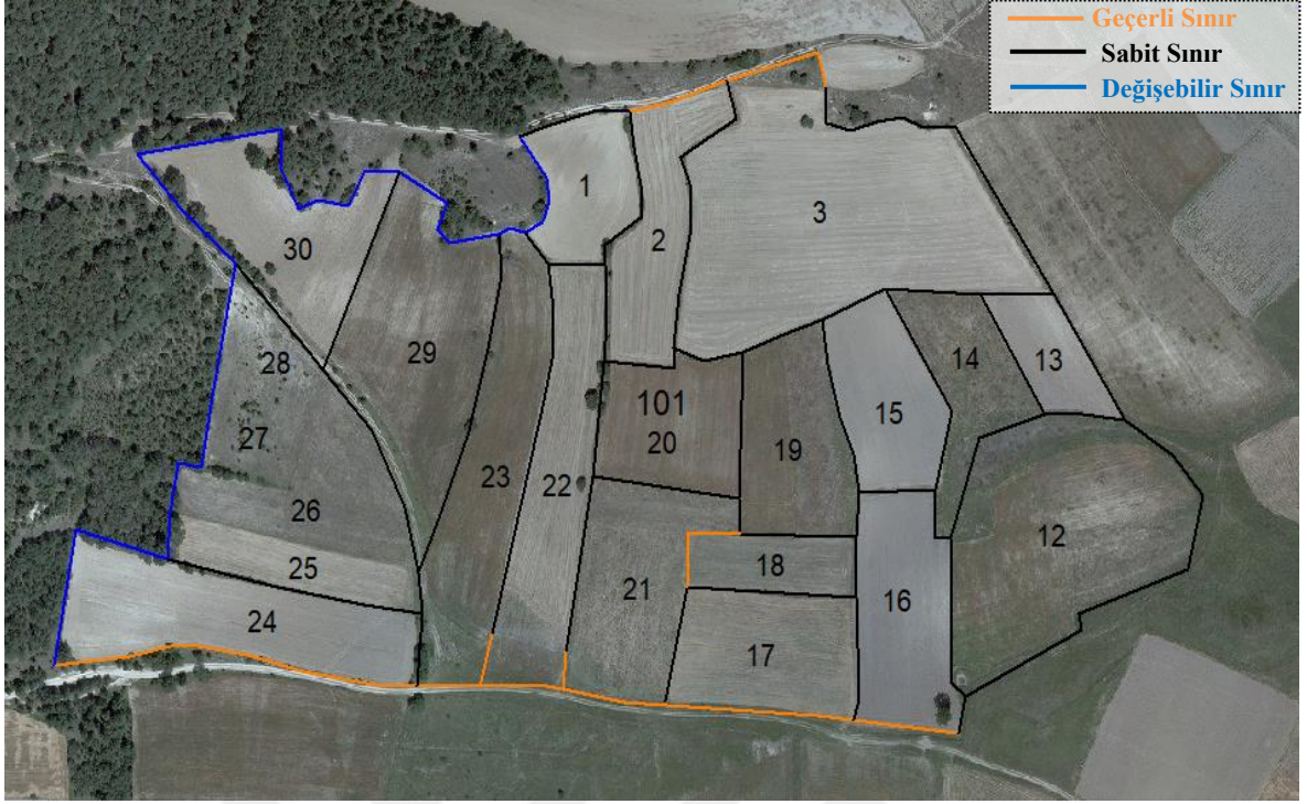
Şekil 1.39. Sınırı genişlemeye elverişli olan yerlerde değişebilir sınır tipinin kullanıldığı durum
