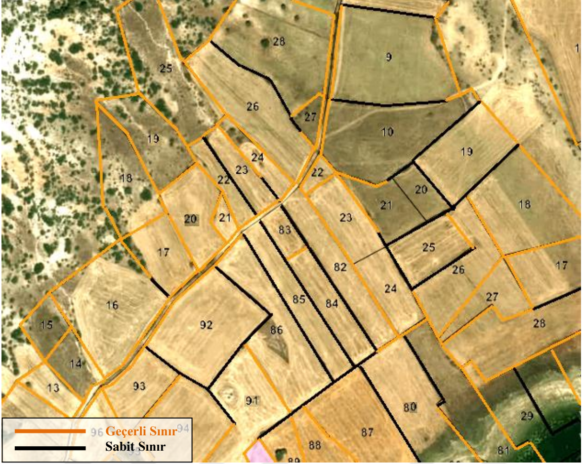
Şekil 3.6. Kütahya ili Sofçu birimi yenileme çalışmaları sonucu üretilen projenin uydu görüntüsü ile çakışık hali
