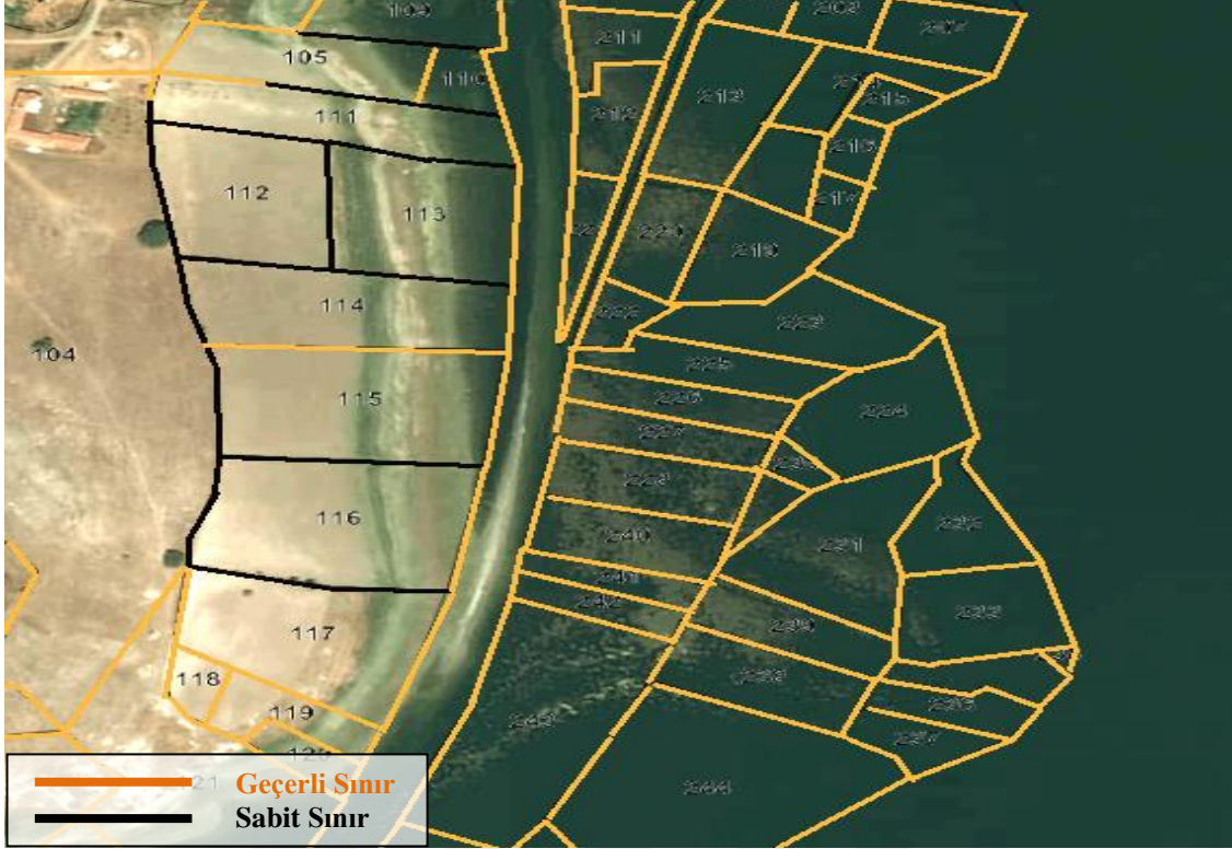
Şekil 3.9. Kütahya ili Sofçu birimi yenileme çalışmaları sonucu üretilen projenin uydu görüntüsü ile çakışık hali
