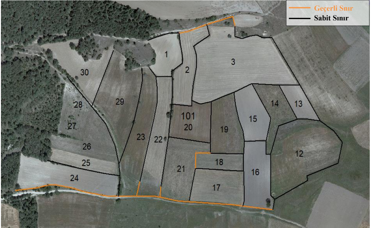
Şekil 1.38. Sabit sınırlar ile geçerli sınırların çakıştırılmış hali
