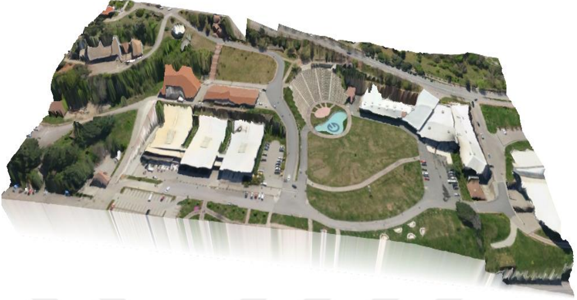
Şekil 40. Ortofotonun RTF- Multiküadratik-Dairesel dik koni enterpolasyon yöntemi ile elde edilen SAM' ın üzerine bindirilmesi
