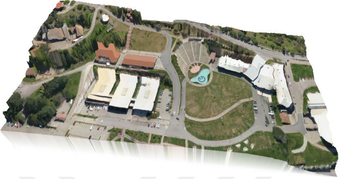
Şekil 34. Ortofotonun IDW-Shephard enterpolasyon yöntemi ile elde edilen SAM' ın üzerine bindirilmesi
