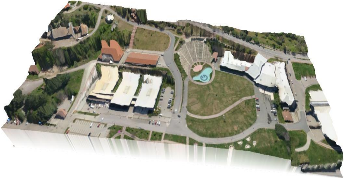
Şekil 43. Ortofotonun Kriging yöntemi-Ordinary kriging enterpolasyon yöntemi ile elde edilen SAM' in üzerine bindirilmesi
