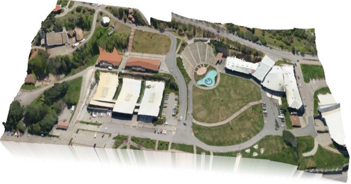
Şekil 29. Ortofotonun kuadratik enterpolasyon yöntemi ile elde edilen SAM' ın üzerine bindirilmesi
