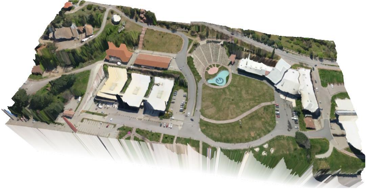
Şekil 33. Ortofotonun bi-kübik enterpolasyon yöntemi ile elde edilen SAM' ın üzerine bindirilmesi
