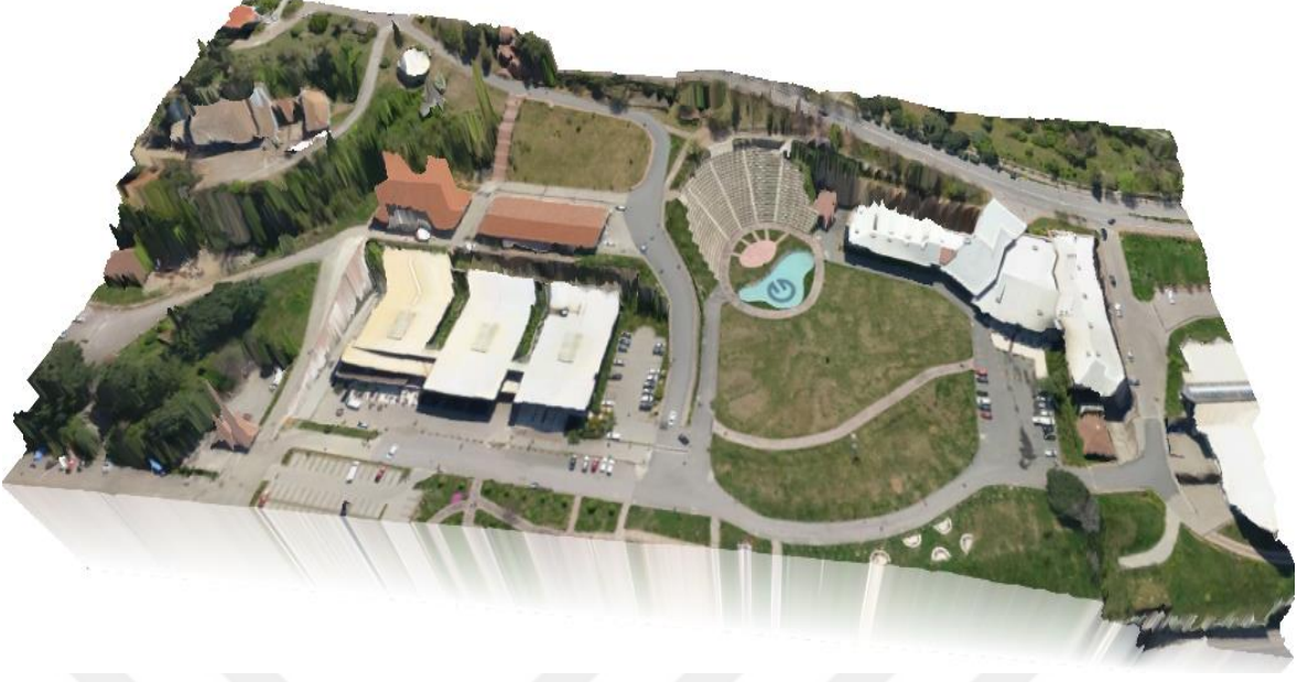
Şekil 32. Ortofotonun bi-kuadratik enterpolasyon yöntemi ile elde edilen SAM' ın üzerine bindirilmesi
