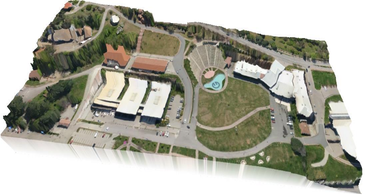
Şekil 35. Ortofotonun RTF-Gauss enterpolasyon yöntemi ile elde edilen SAM' ın üzerine bindirilmesi
