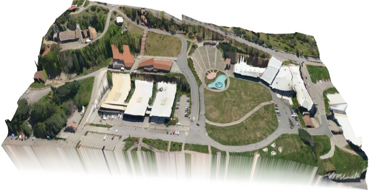
Şekil 37. Ortofotonun RTF-Ters Multiküadratik enterpolasyon yöntemi ile elde edilen SAM' ın üzerine bindirilmesi
