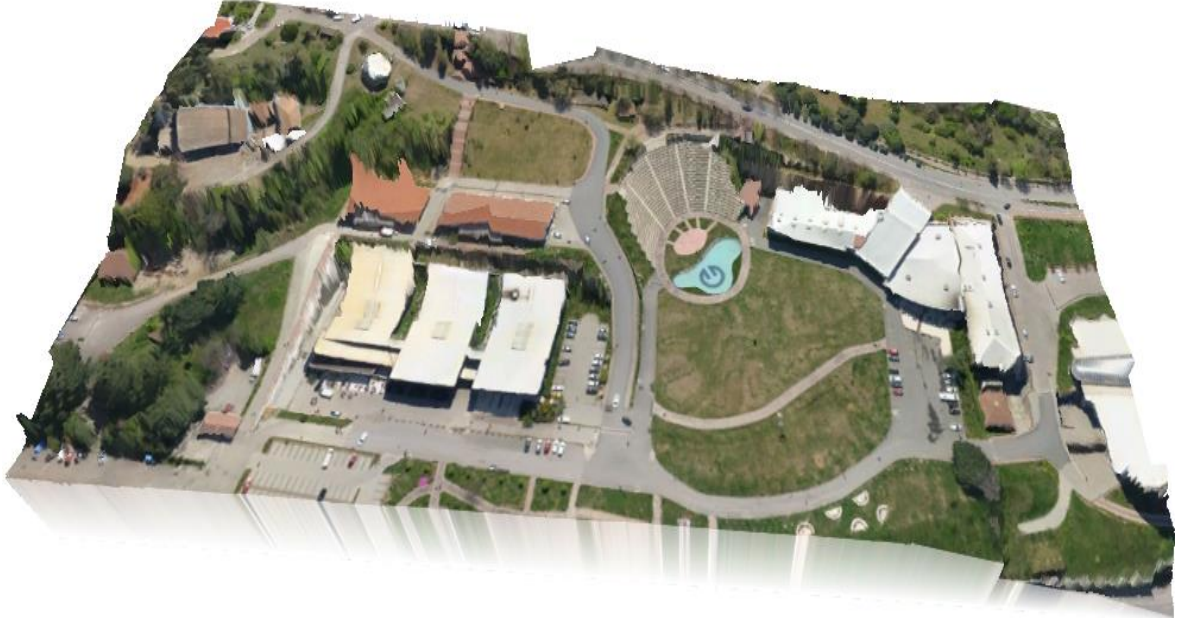
Şekil 31. Ortofotonun bi-lineer enterpolasyon yöntemi ile elde edilen SAM' in üzerine bindirilmesi
