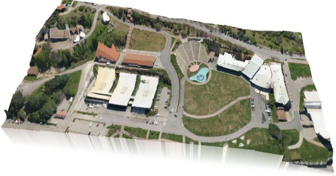
Şekil 28. Ortofotonun lineer enterpolasyon yöntemi ile elde edilen SAM' ın üzerine bindirilmesi
