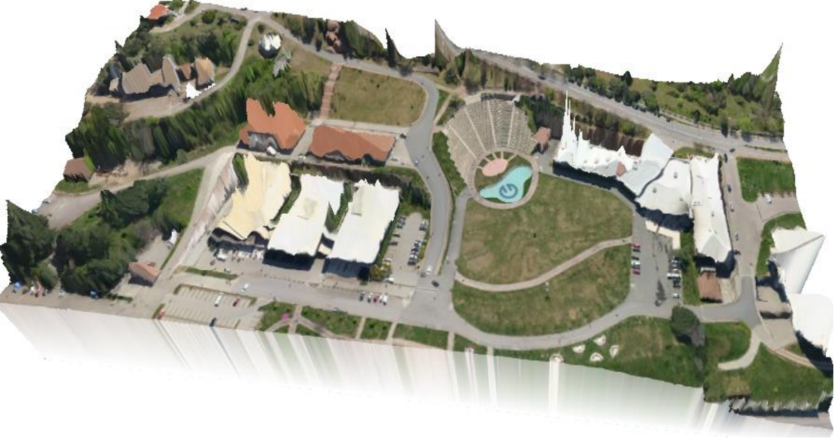
Şekil 39. Ortofotonun RTF-Doğal Kübik Splayn enterpolasyon yöntemi ile elde edilen SAM' in üzerine bindirilmesi
