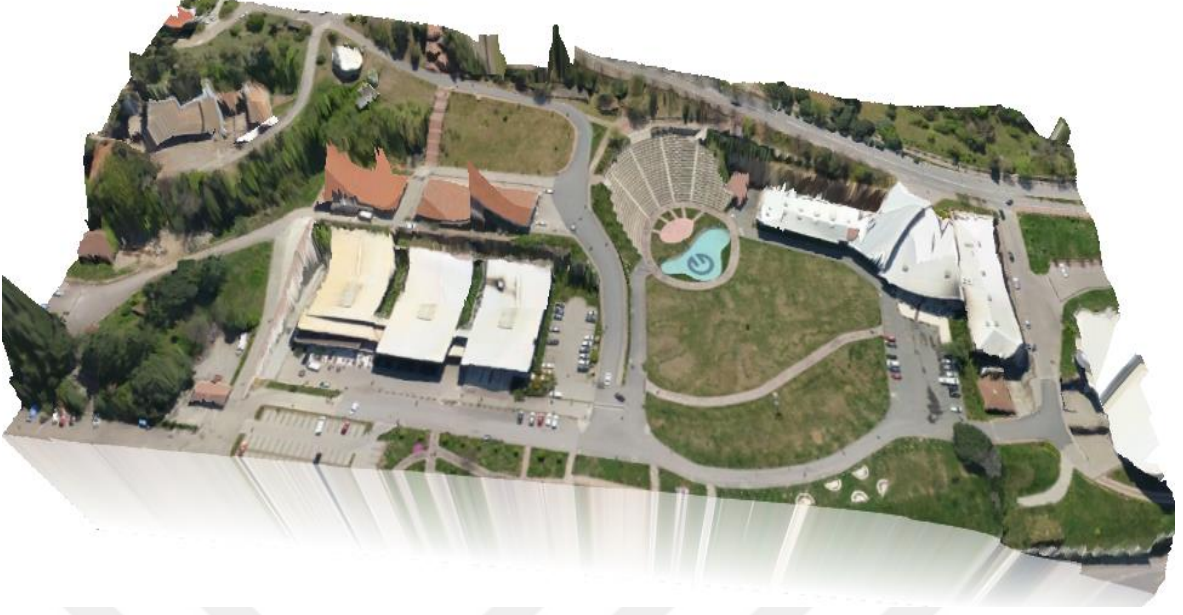
Şekil 30. Ortofotonun kübik enterpolasyon yöntemi ile elde edilen SAM' in üzerine bindirilmesi
