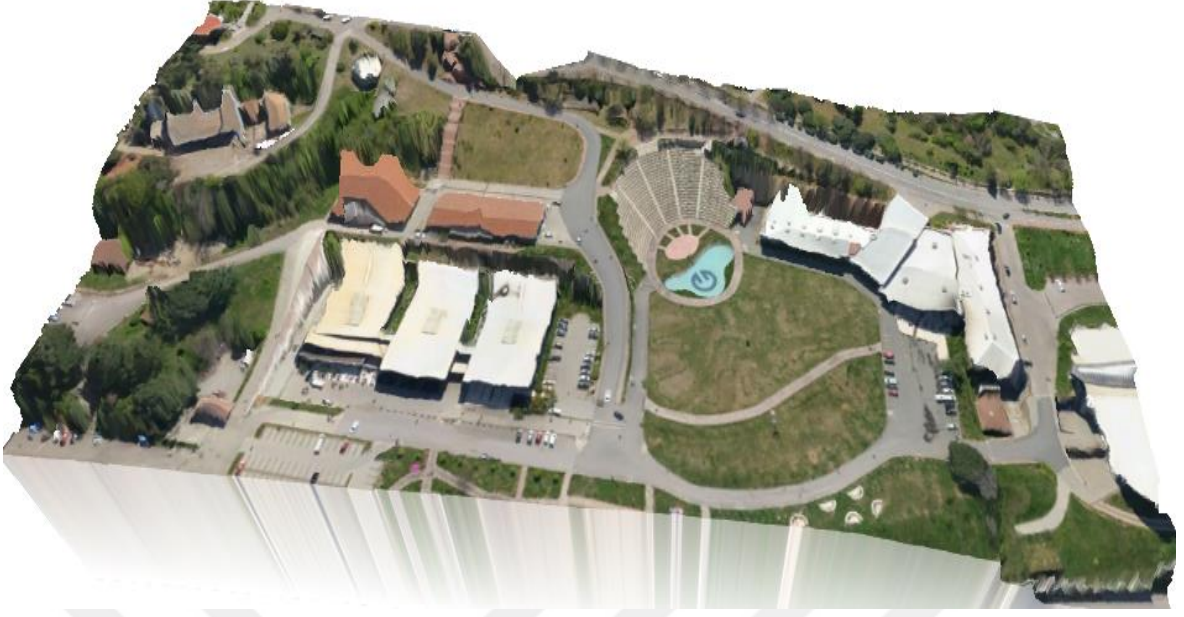
Şekil 42. Ortofotonun RTF-Multikvadratik-İki yapraklı dairesel hiperboloid enterpolasyon yöntemi ile elde edilen SAM' in üzerine bindirilmesi
