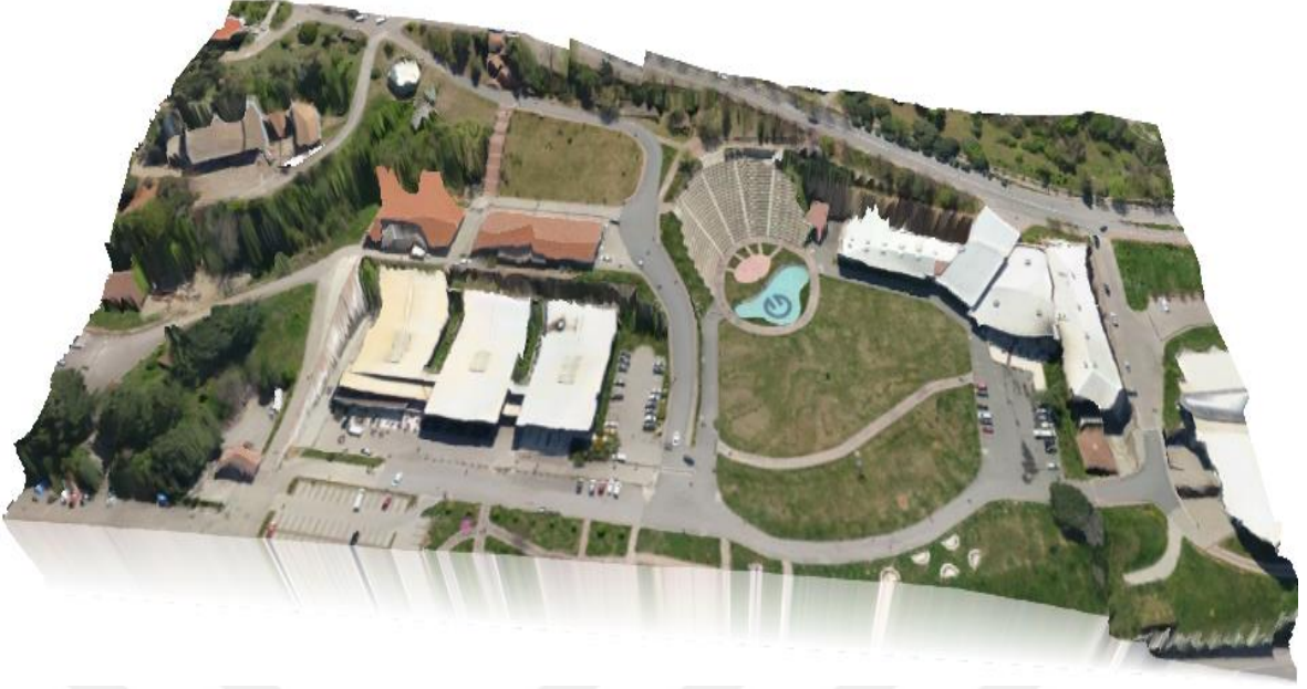
Şekil 38. Ortofotonun RTF-Multilog enterpolasyon yöntemi ile elde edilen SAM' in üzerine bindirilmesi
