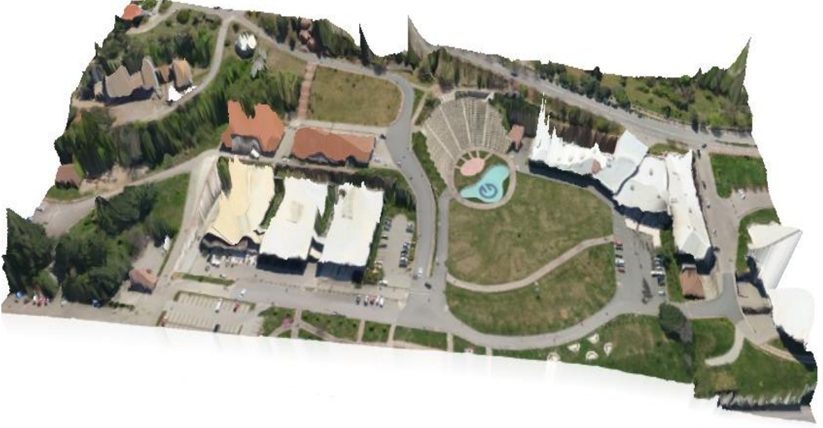
Şekil 36. Ortofotonun RTF-Küçük Splayn enterpolasyon yöntemi ile elde edilen SAM' ın üzerine bindirilmesi
