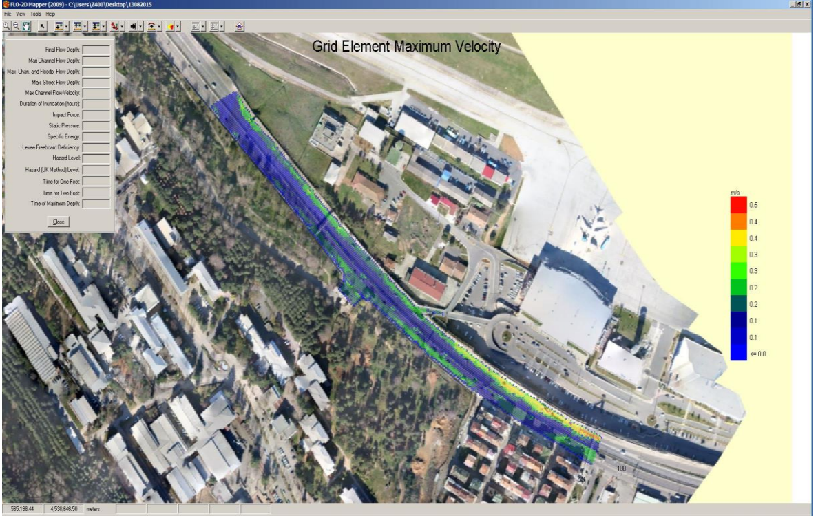
Şekil 32. Maksimum hız değerleri (Fotogrametrik Yöntem)
