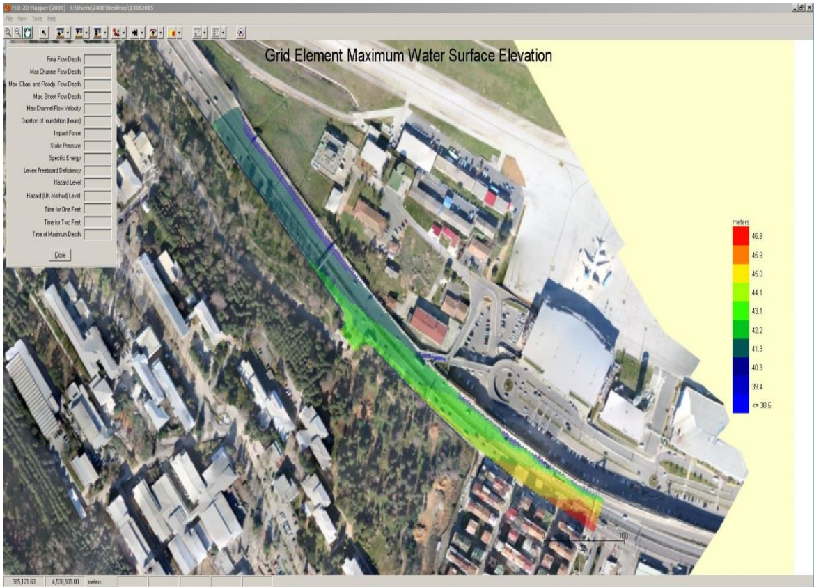
Şekil 22. Maximum su yüzeyi yükseklikleri (Fotogrametrik Yöntem)
