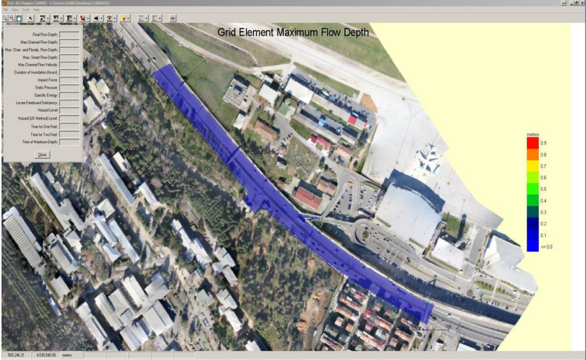
Şekil 23. Her pikseldeki akış derinlik miktarları (Fotogrametrik Yöntem)
