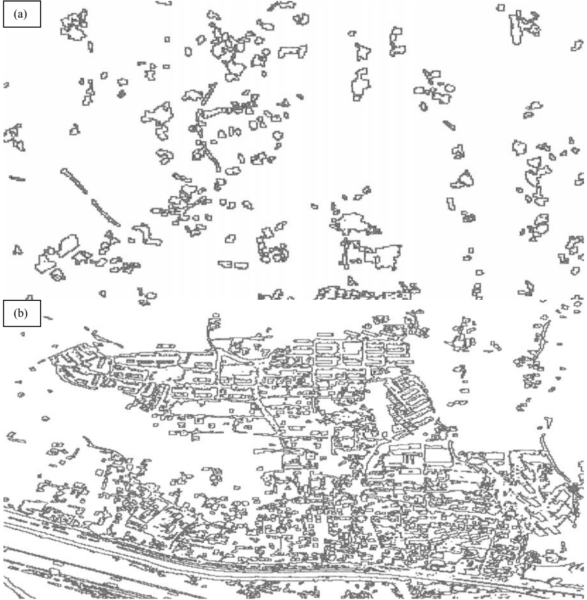
Şekil 22. Canny Kenar belirleme yöntemiyle binaların belirlenmesi: a) Kırsal-1 alan ve b) Kentsel-1 alan.
